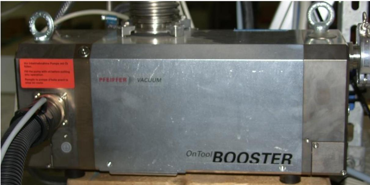
Abb. 9-7: Seitenkanalhochvakuumpumpe OnTool Booster 150
