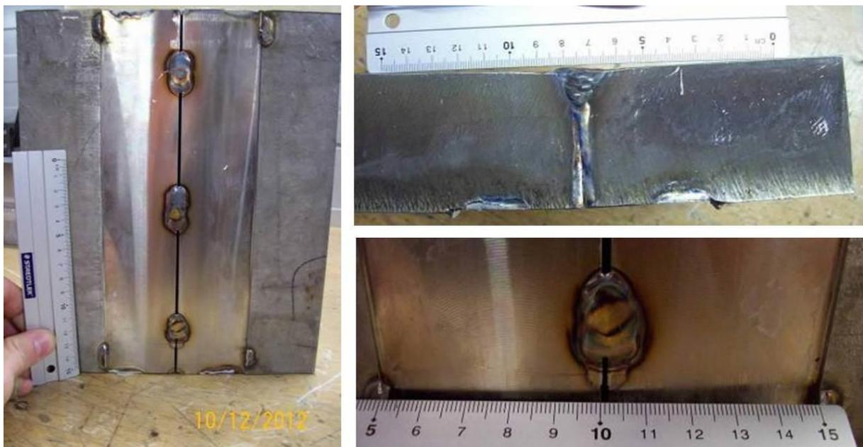
Abb. 8-12: Verzug und Spalt an BSM Probe nach Einbringen der WIG-Wurzel
