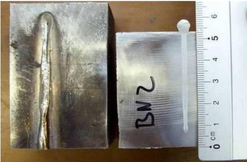
Abb. 8-9: EB-Schweißung mit noch nicht optimaler Schweißnahtgeometrie
