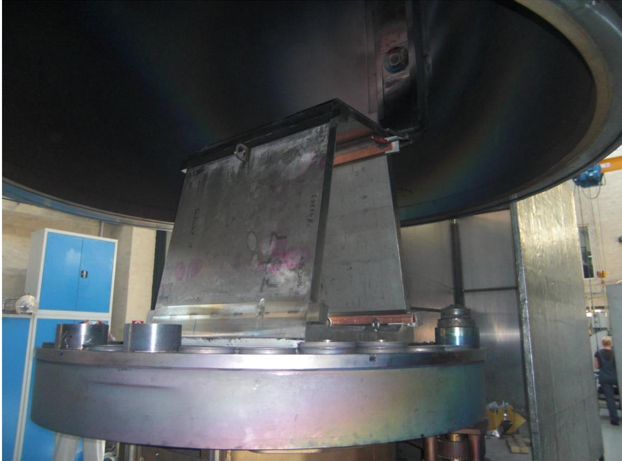
Abb. 5-8: EB-Prototyp unter der Vakuumglocke (geöffnet) beim Elektronenstrahlschweißen.
