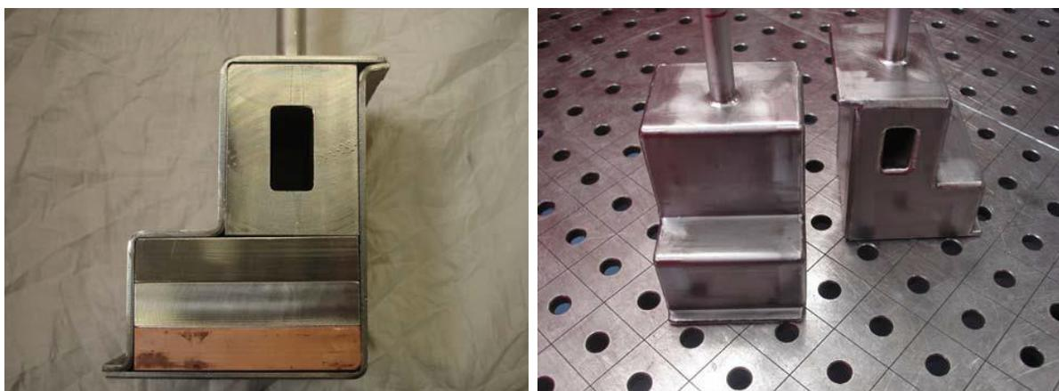
Abb. 12-5: Testkörper V1 vor HIP Prozess
