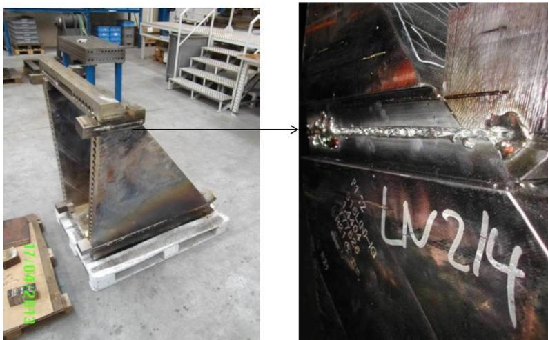
Abb. 7-17: Durchgeschweißte, fehlerhafte EB-Naht am DWMF Prototyp
