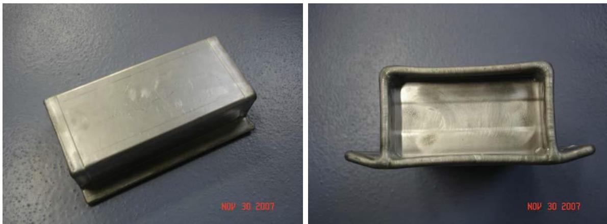
Abb. 12-4: Testkörper V1 nach HIP Prozess
