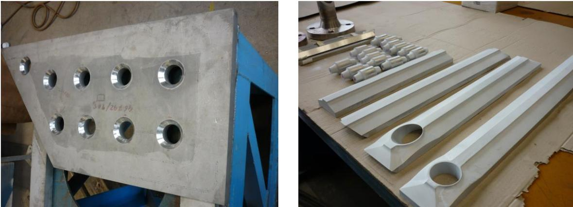
Abb. 6-16: Einzelteile des DWMF Vorprototypen (Bolzenvariante) vor dem Zusammenbau
