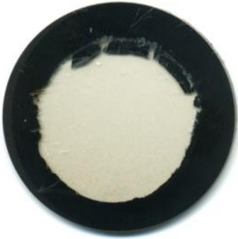
Abb. 11-16: Titan beschichteter Diamant
