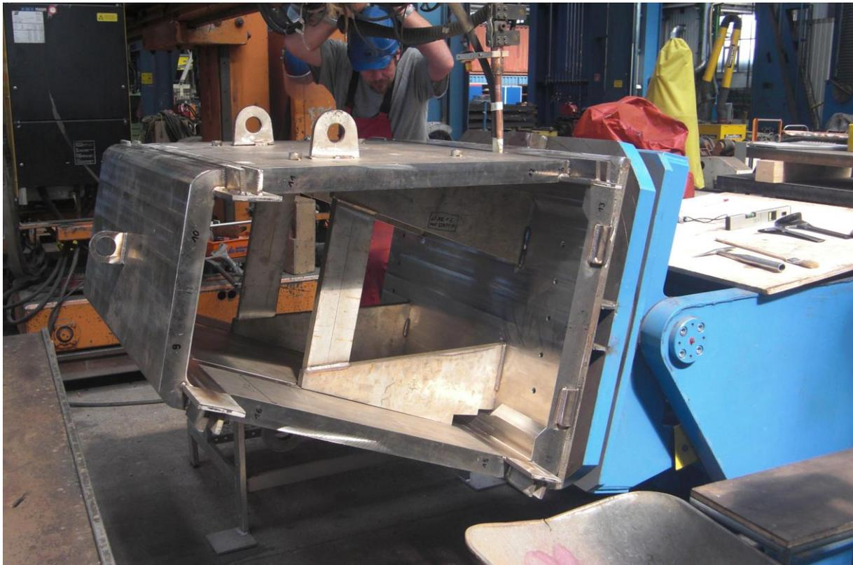
Abb. 5-5: UP-WIG-Prototyp während des Schweißens
