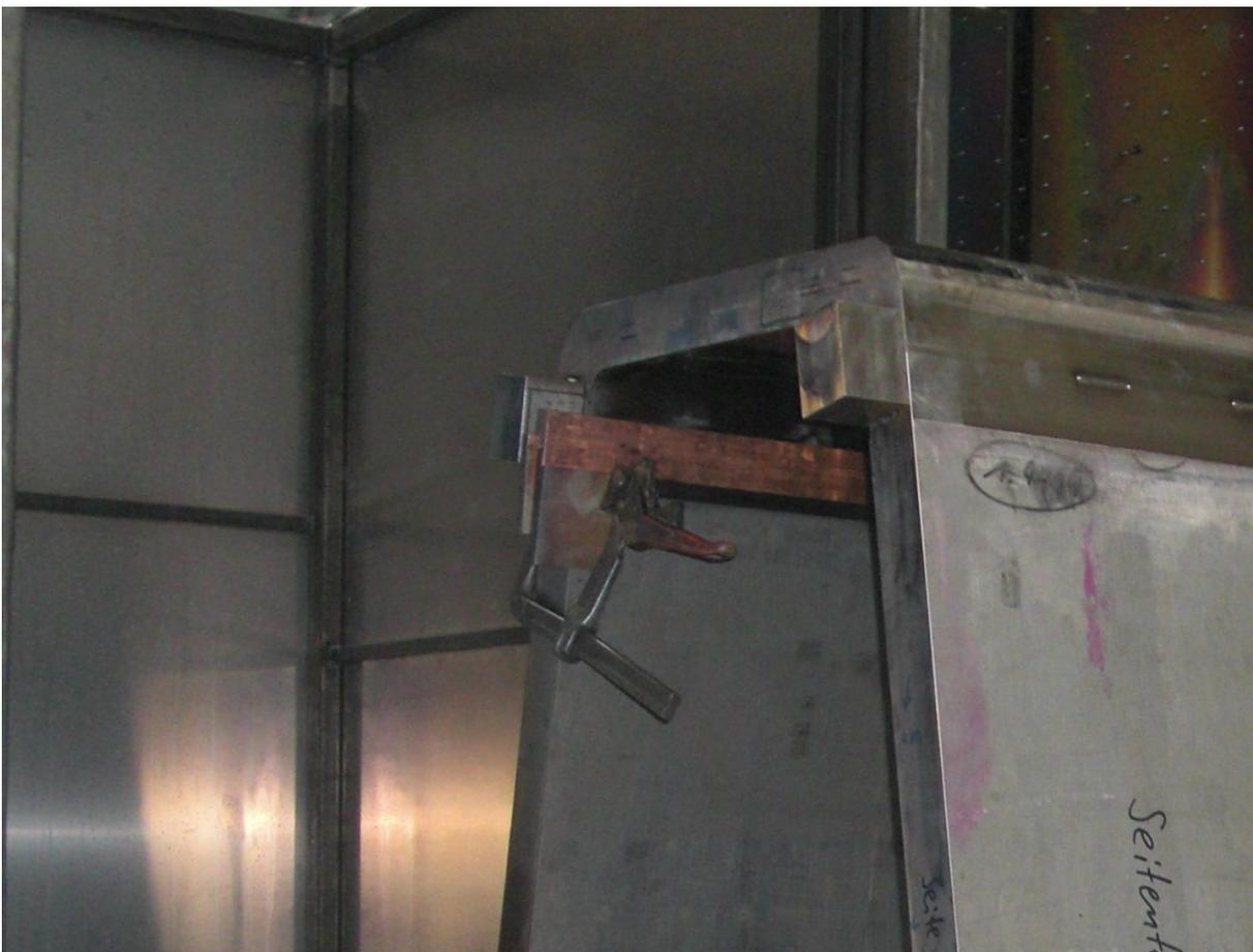
Abb. 5-7: Elektronenstrahleinlaufzone und Strahlfänger beim EB-Prototypen
