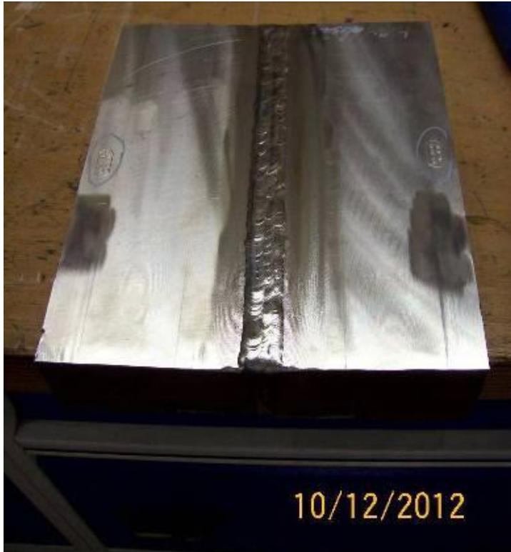
Abb. 8-11: BSM Schweißnaht in Realgeometrie nach Einbringen der Wurzellage
