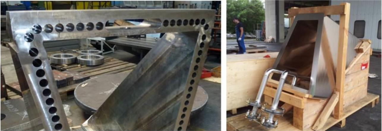
Abb. 7-18: DWMF Prototyp während der Fertigung (links) und vor der Auslieferung (rechts)
