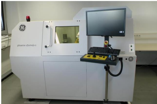
Abb. 10-1: Röntgen Computertomographiegerät v|tome|x s von der Firma GE
