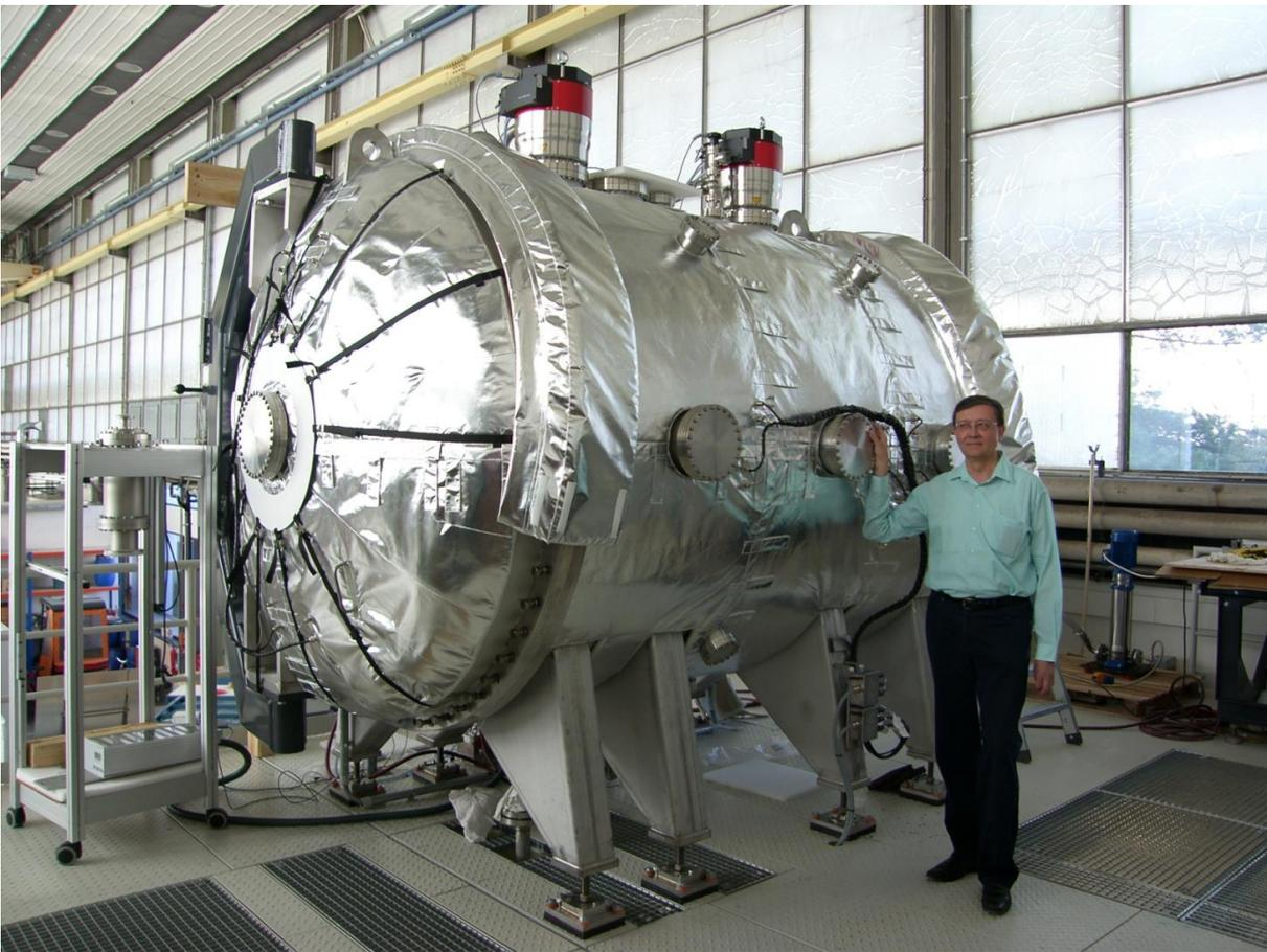
**Abb. 9-5: Vakuumrezipient mit Heizmanschetten und Vakuumpumpensatz**
