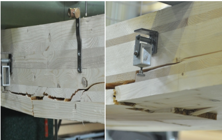
Bild 3-22: Typisches Versagen bei Versuchsreihe P200REF durch Erreichen der Biegefestigkeit in der unteren Randlamelle (10 von 10 PK)
