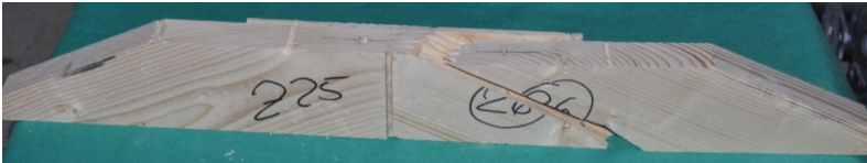
Bild 4-19: Typische Bruchbilder bei Reihe EL-Z-25 ( \alpha = 25^\circ )
