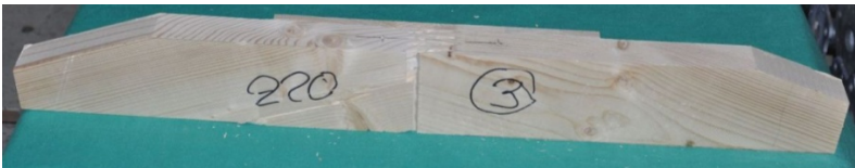
Bild 4-17: Typische Bruchbilder bei Reihe EL-Z-15 ( \alpha = 15^\circ )
