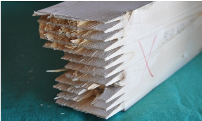
Bild 3-35: schlechte Verklebung der Universal-Keilzinkenverbindung bei Prüfkörper BSH600-7
