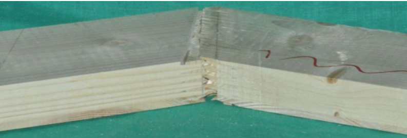
Bild 4-29: Typisches Versagen bei Reihe EL-B-25 ( \alpha = +25^\circ )
