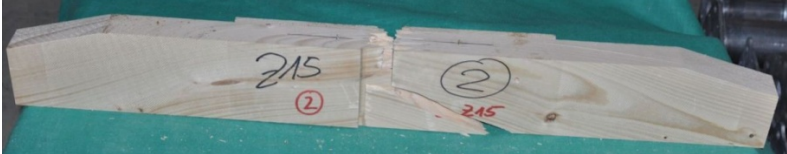
Bild 4-17: Typische Bruchbilder bei Reihe EL-Z-15 ( \alpha = 15^\circ )
