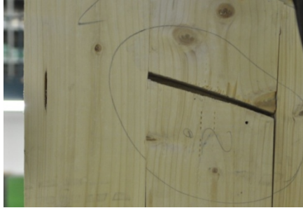
Bild 3-51: Stumpf gestoßene Längslamelle im Eckstück des Prüfkörpers RE600-90-3
