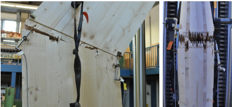
Bild 3-49: Prüfkörper RE600-115-5 nach dem Erreichen der Höchstlast
