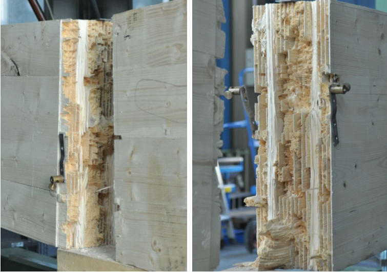
Bild 3-19: Typisches Versagen bei Versuchsreihe S600LFJ durch Erreichen der Biegefestigkeit in der Universal-Keilzinkenverbindung (15 von 15 PK)
