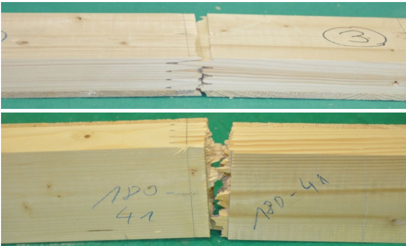
Bild 4-27: Typisches Versagen bei Reihe EL-B-0 ( \alpha = 0^\circ )
