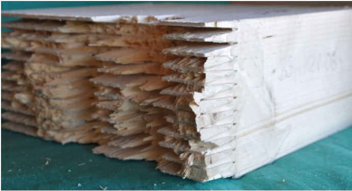
Bild 3-34: gute Verklebung der Universal-Keilzinkenverbindung bei Prüfkörper BSH600-8
