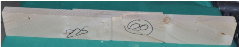
Bild 4-18: Typische Bruchbilder bei Reihe EL-Z-20 ( \alpha = 20^\circ )
