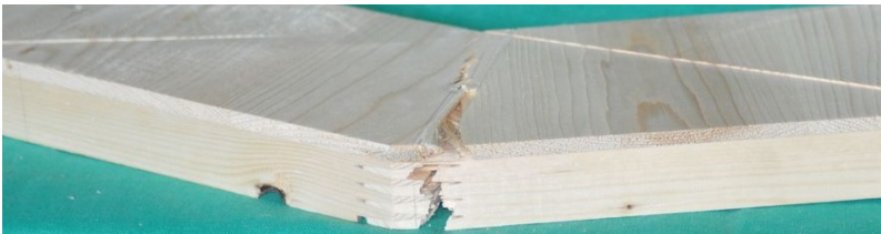
Bild 4-30: Typisches Versagen bei Reihe EL-B-15 ( \alpha = -15^\circ )
