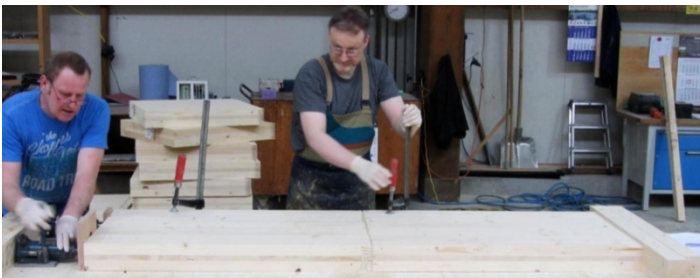
Bild 3-2: Verkleben der Universal-Keilzinkenverbindung bei einer dreilagigen Brettsperrholzplatte zur Herstellung von Lamellen-Zugprüfkörpern
