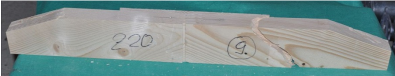
Bild 4-18: Typische Bruchbilder bei Reihe EL-Z-20 ( \alpha = 20^\circ )
