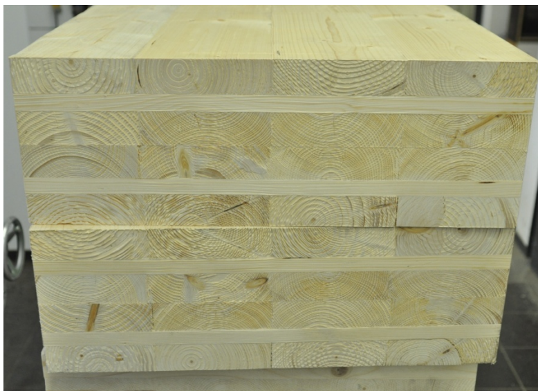
Bild 3-12: Typisches Versagensbild bei Versuchsreihe D600KF mit lokalem Druckversagen in der Kontaktfuge
