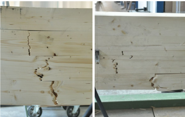
Bild 3-20: Typisches Versagen bei Versuchsreihe S600REF durch Erreichen der Biegefestigkeit in den Längslamellen der Zugzone (15 von 15 PK)
