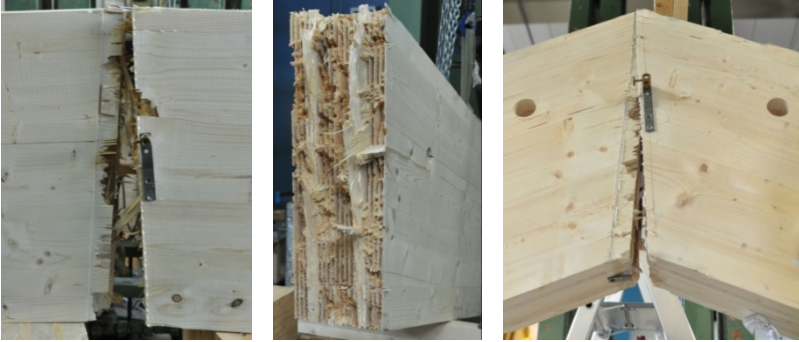
Bild 3-39: Beispiele für das typische Versagen bei den Versuchsreihen mit Brettsperrholz-Satteldachträgern; links: Versuchsreihe SD600-05, Mitte: Versuchsreihe SD600-15; rechts: Versuchsreihe SD600-25
