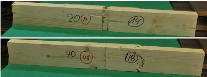
Bild 4-14: Typische Bruchbilder bei Reihe EL-Z-0 ( \alpha = 0^\circ )
