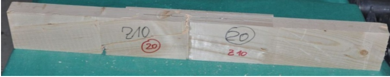
Bild 4-16: Typische Bruchbilder bei Reihe EL-Z-10 ( \alpha = 10^\circ )
