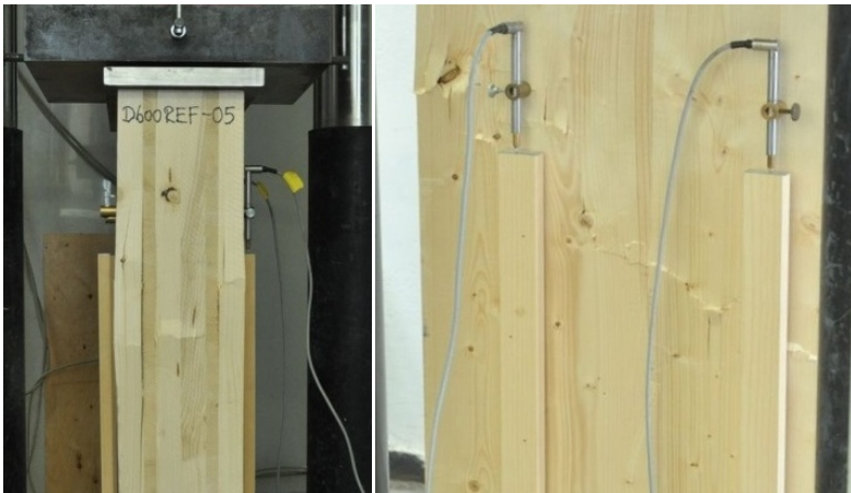
Bild 3-10: Typisches Versagensbild bei Versuchsreihe D600REF mit Druckfalten in den Lamellen der Längslagen
