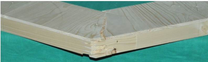
Bild 4-31: Typisches Versagen bei Reihe EL-B-25 ( \alpha = -25^\circ )
