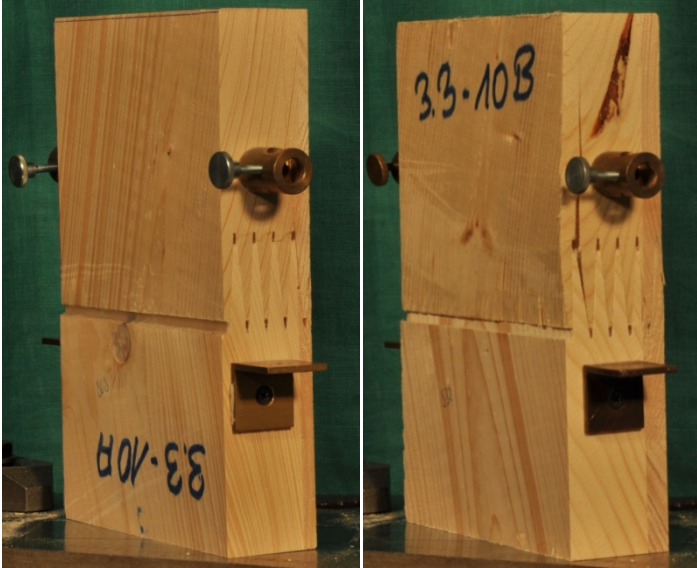
Bild 4-23: Typisches Versagen bei Reihe EL-D-15 ( \alpha = 15^\circ )
