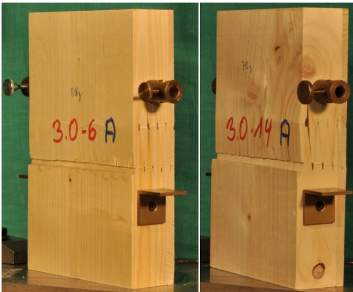
Bild 4-22: Typisches Versagen bei Reihe EL-D-0 ( \alpha = 0^\circ )
