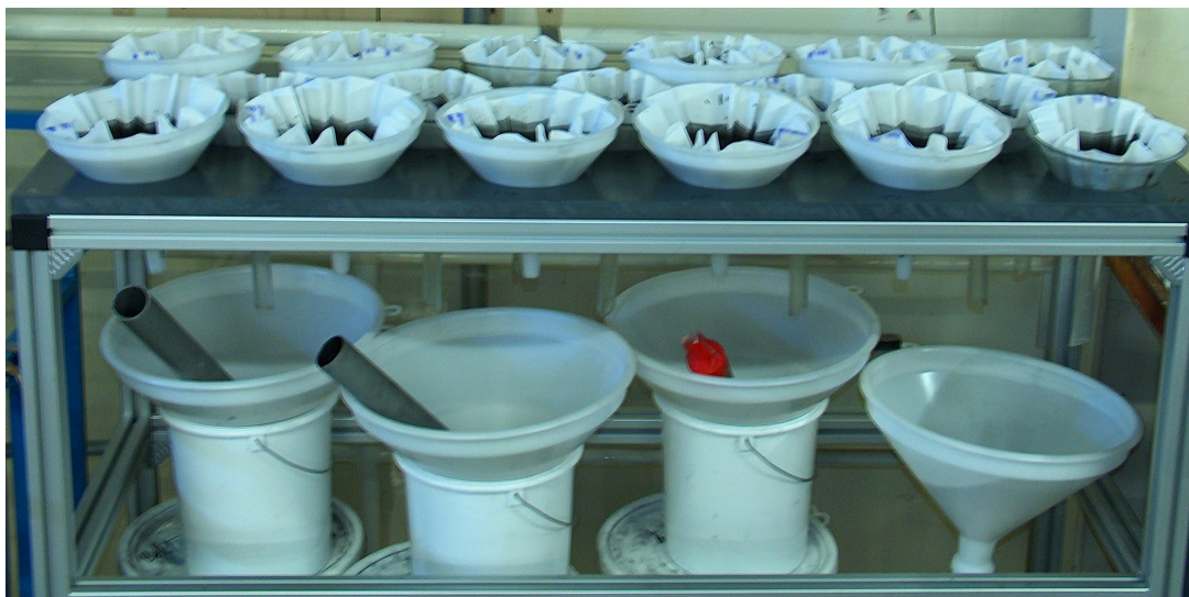
Abbildung A.3: Trichtertisch zur Aufnahme von 17 Filter für die Trennung von Feststoff und Extrakt
