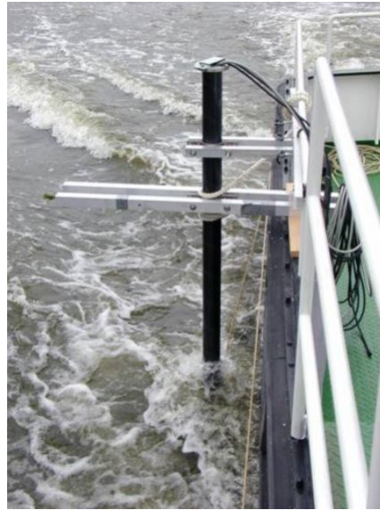
Abbildung 3.5: Das DSLP - Analysegerät (schwarze Röhre) im Einsatz am Schiff, zur Vermessung des Untergrundes; Quelle( generalacoustics.com )
