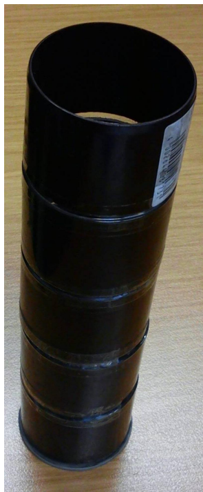
Abbildung 5.1: Modular aufgebauter Sedimentationszylinder, bestehend aus fünf Segmenten die mit Klebeband zusammengefügt und abgedichtet sind
