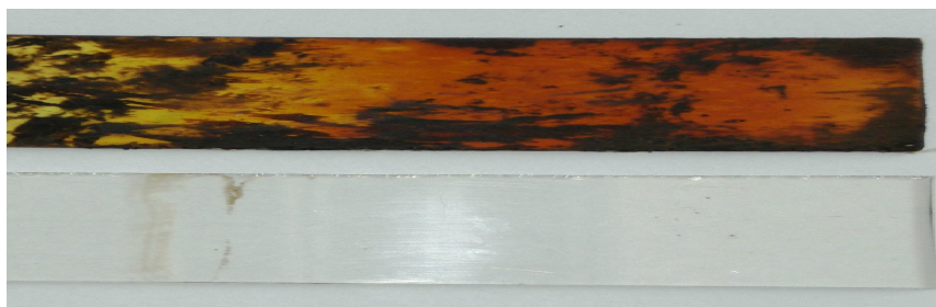
Abbildung 5.2: (Oben) PMMA nach einer Woche im bioliq ® -Schwelterer. (Unten) Ausgangszustand des PMMAs
