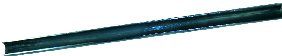
Abbildung 6.3: Endgültiger Stechbohrer: halbiertes Metallrohr
