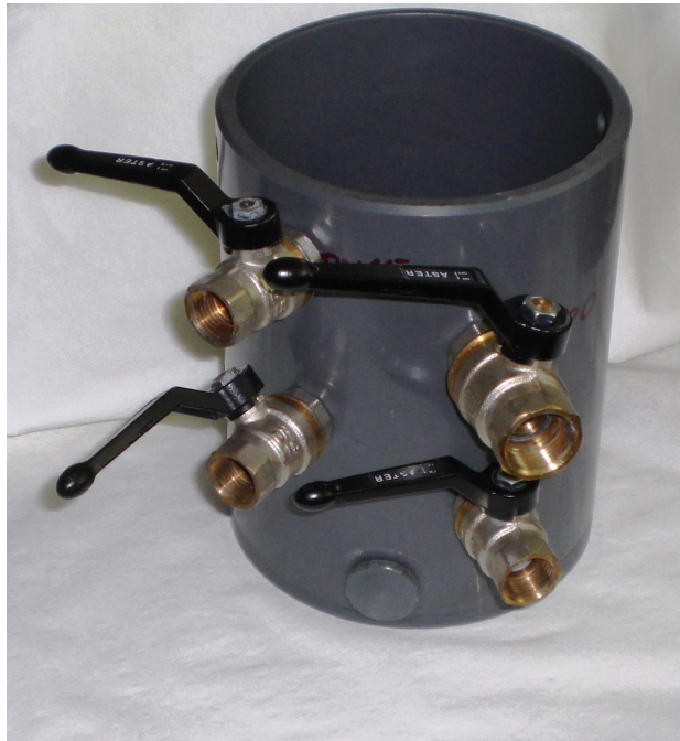
Abbildung A.4: Versuchsturm aus PVC mit 2L Volumen, zur Erprobung von Ventilen und Probenehmern
