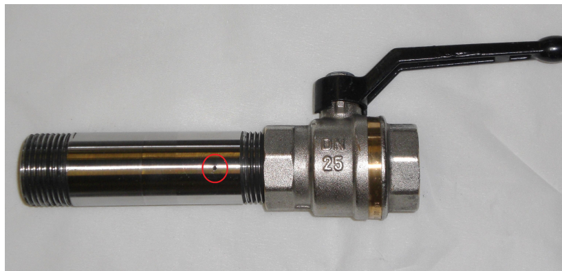
Abbildung 8.1: Metallrohr mit einseitig aufgeschraubten Kugelhahn und zweiten Gewinde zur Installation am entsprechenden Ventil. Bohrloch (roter Kreis) ermöglicht es der eingeschlossenen Luft zu entweichen.
