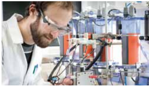
Joachim Langner beim Anschließen von Messkabeln an eine Redox-Flow-Batterie
