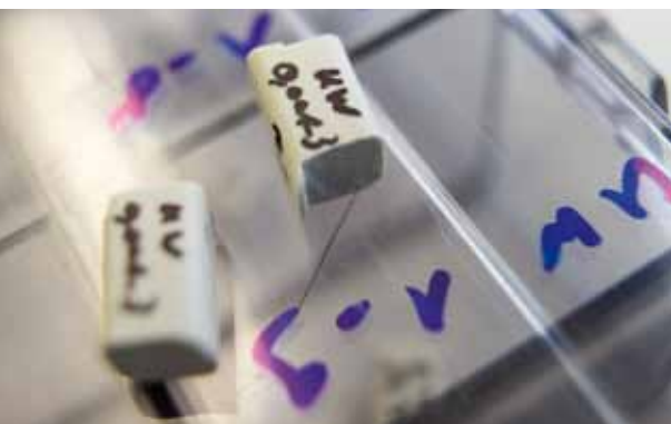
Bruchstücke nach den mechanischen Tests, an denen die bruchauslösenden Defekte gesucht, deren Größe und Form bestimmt und somit die Bruchverläufe rekonstruiert werden
