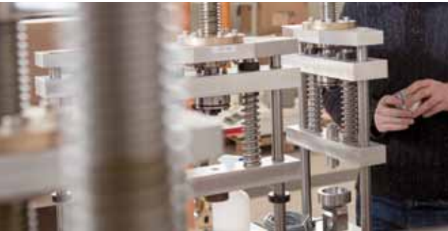
Prüfstände zur Untersuchung des unterkritischen Risswachstums an Porzellan-Proben
