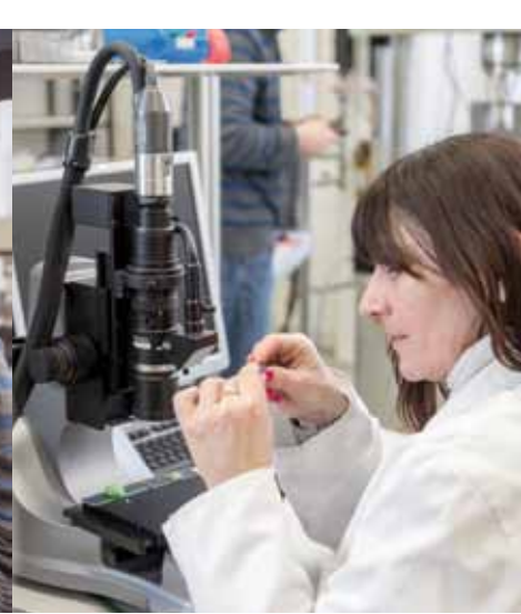
Dr. Claudia Bucharsky bei der fraktographischen Nachuntersuchung an den Bruch- flächen der getes- teten Proben
