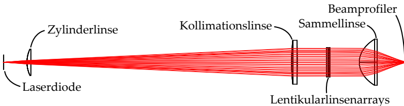
Abb. 6.13.: Schnittbild durch das Zemax-Modell des Messaufbaus und Strahlengang.
