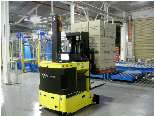
Abb. 4.1.: Ladungsträgeraufnahme mit einem fahrerlosen Transportsystem.
