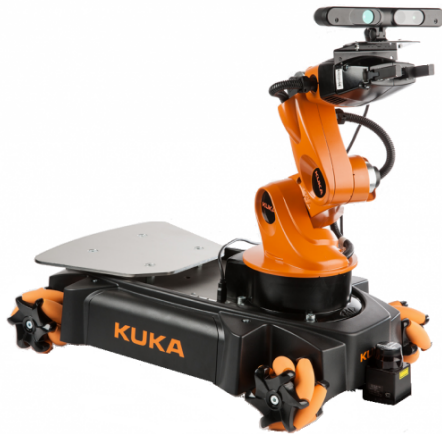
Abb. 3.3.: Mobiler Roboter youBot der Firma KUKA mit 2D-Laserscanner Hokuyo URG-04LX-UG01 sowie 3D-Sensor Asus Xtion PRO LIVE am Knickarm montiert.
