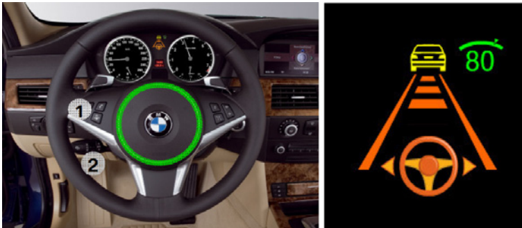
Bild 2.4: HMI des Stauassistenten von SCHALLER: Taste (1) und Lenkstockhebel (2) zur Bedienung von Quer- und Längsführung. Ein grüner Leuchtring am Lenkrad zeigt an, ob die Querführung aktiv ist - der Fahrer kann die Hände vom Lenkrad nehmen; entnommen aus [127].
