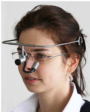
Bild 6.6: Versuchsperson mit Dikablis Blickerfassungs-System [48].
