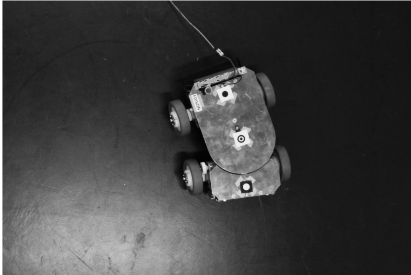
Abbildung 7.13.: Versuch A6: Radmaterial Thermoplast THKS Shore 85 A
