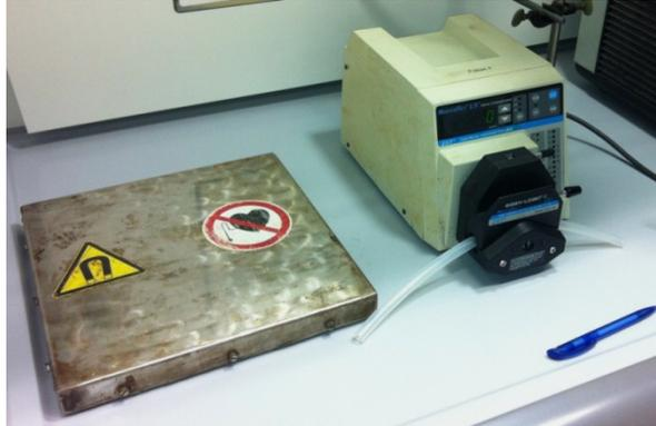
**Abbildung 7: Magnetplatte und Schlauchpumpe, die zur Partikelwaschung vor der Immobilisierung eingesetzt wurden.**
