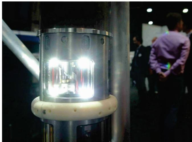
Abb. 9: Ausschnitt der GeoKam-Videoinspektionssonde bei der Geotherm-Messe in Offenburg
