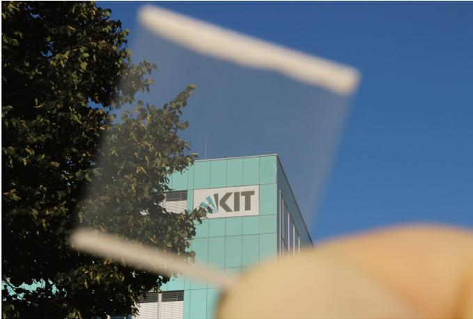
**Abbildung 7.10:** Transparente PEDOT:PSS/AgNW-Elektrode auf flexiblem PET-Substrat.
