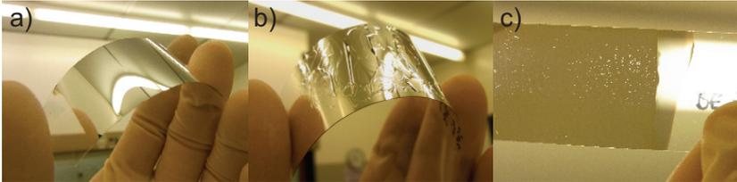
**Abbildung 5.1:** Zur Bestimmung der Haftung der Silberschicht auf flexibler PET-Folie wurden Biegetestes (a) mit und (b) ohne Haftvermittler durchgeführt. Dabei kann die Haftung durch den Einsatz von HDMS, TI PRIME und Acrylhaftvermittlern deutlich verbessert werden. (c) Die Verwendung von HDMS und TI PRIME führt jedoch auch zu Inhomogenitäten in der Silberschicht.
