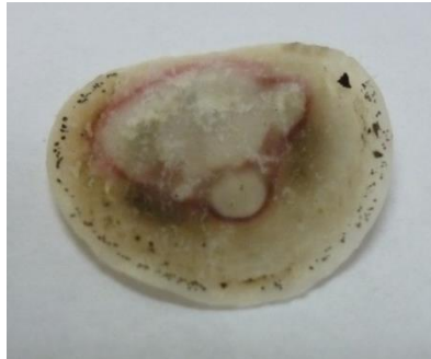
Abb. 66: Separator (GFC/Whatman) nach einem galvanostatischen Batterietest des \text{LiMnFeF}_6 -Komposits gegen \text{Li}^+/\text{Li} . Die rote Farbe am Separator ist charakteristisch für rubinrotes \text{MnF}_3 .
