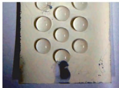
Unbelichtete Oberfläche (oben), nach Belichtung (Mitte), Haftung von Flüssigkeiten nur auf den belichteten Bereichen (unten).
