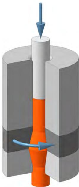
Das dreiteilige Umformwerkzeug kann kurze, zylindrische Rohlinge (rot und hellgrau) durch hohen Druck und Scherspannung plastisch verformen und zu langen Stangen verbinden.
