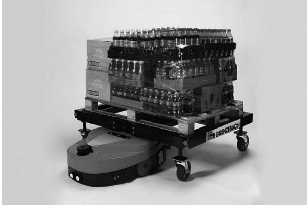
Abbildung 3.14: Unterfahrschlepper (Quelle: Grenzebach)
