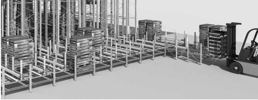
Abbildung 3.12: SmooV ASRV im Einsatz in der Lagervorzone
