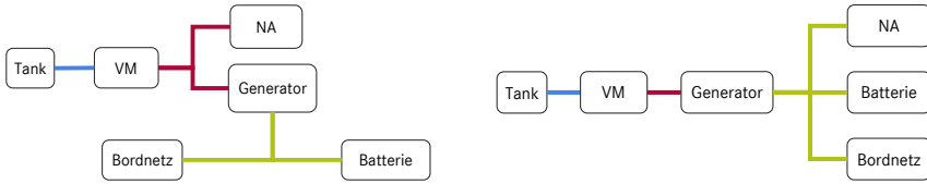
Abb. 6.19: Energiepfadvariation durch riemengetriebene und elektrisch angetriebene Nebenaggregate [103]
