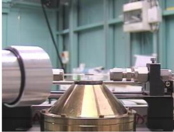
Abb. 2-6. Aufbau der in situ Zelle mit einer Glaskapillare und Heizofen [120].
