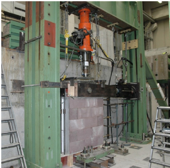
Abb. 4-27 Versuchsstand der kleinformatischen Wandversuche
