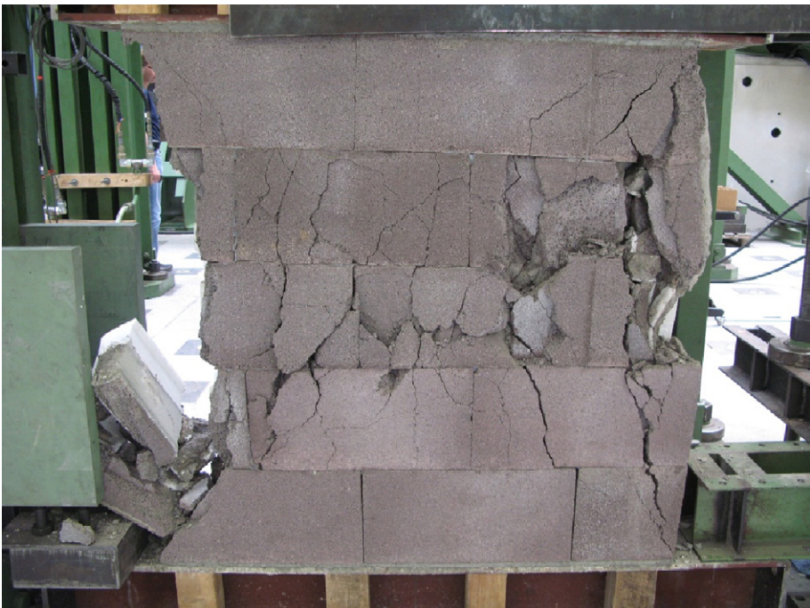
Abb. 4-33 Wand 8 kurz vor (oben) und kurz nach dem Versagen (unten)
