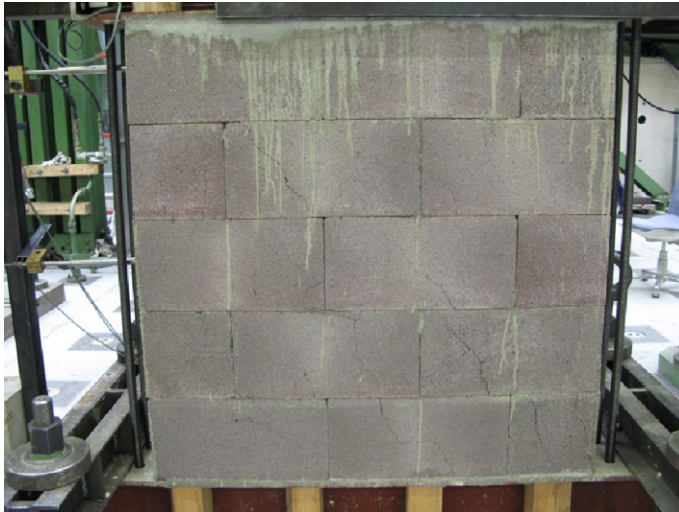
Abb. 4-41 Um seitliche Abspannungen erweiterter Versuchsaufbau
