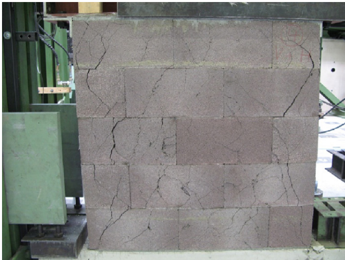
Abb. 4-40 Rissbild am Ende von Wandversuch 10b
