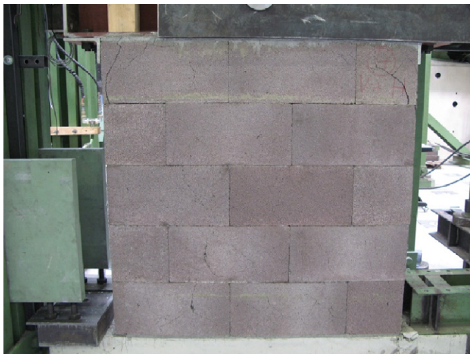
Abb. 4-39 Rissbild von Wandversuch 10a
