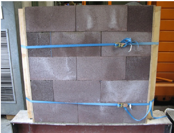
Abb. 4-24 Herstellung der kleinformigen Wandversuche
