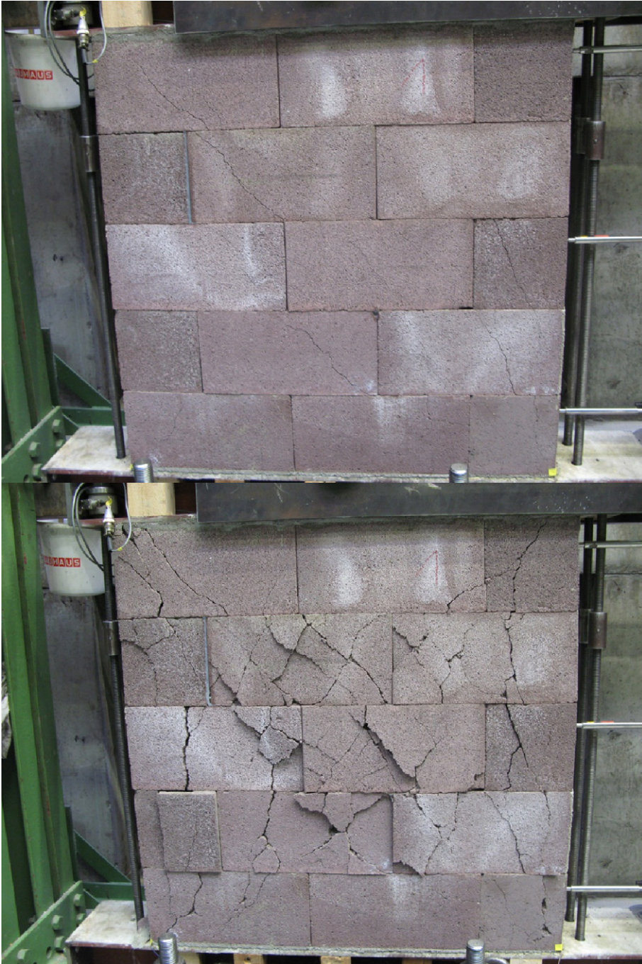
Abb. 4-29 Rissbild bei Erreichen der Maximallast (oben) und am Versuchsende (unten)
