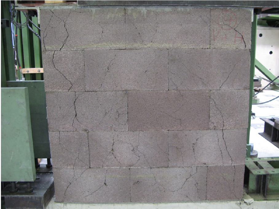
Abb. 6–14 Rissbild am Ende von Wandversuch 10a
