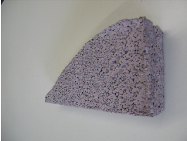
Abb. 3-13 Oberflächencharakteristik des haufwerksporigen Leichtbetons
