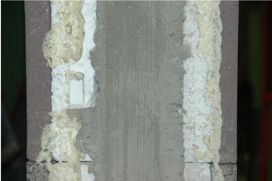
Abb. 4-14 Entkopplung von Schalungsstein und Füllbeton mittels Polystyrol
