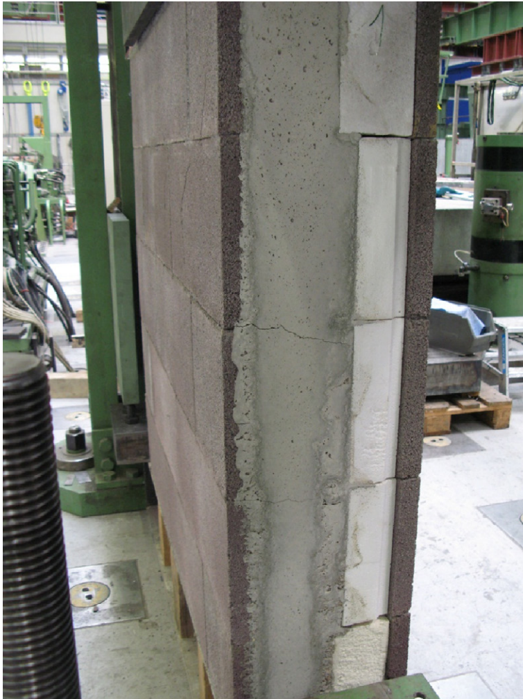
Abb. 4-32 Ausknicken der Randstützen
