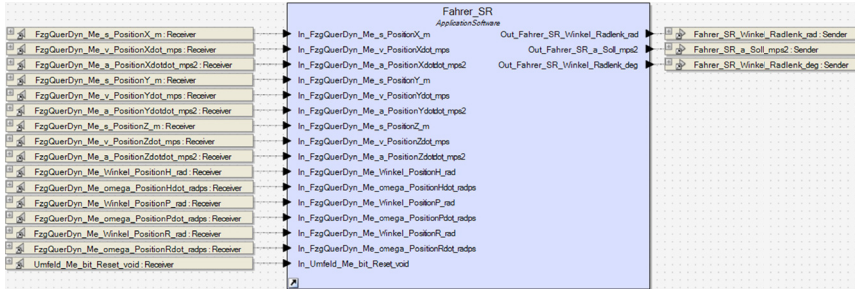
Abb. 4.12: Architekturlayout des virtuellen Fahrers (SystemDesk-Screenshot)
