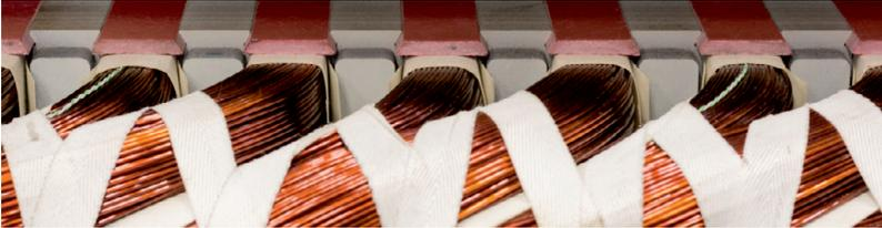
Bild 6.16: Thermoelemente zur Messung der Wicklungstemperatur innerhalb einer Primärteilnut.
