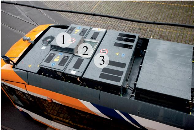
Bild 2.2: Dachansicht einer Straßenbahn der rnv mit Doppelschichtkondensator-speicher. 1) Doppelschichtkondensatorspeicher, 2) Bremswiderstand und 3) Traktionsstromrichter. Zur Verdeutlichung der Komponenten wurden dem Bild die Zahlen hinzugefügt. Foto: rnv
