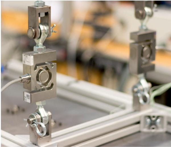
Bild 6.15: Zwei der drei Kraftaufnehmer zur Normalkraftmessung in z-Richtung mit der Anbindung über Gelenkösen und Gabelköpfe zwischen Aluminiumprofil und Gewindestange. Foto: Stefan Hartmann
