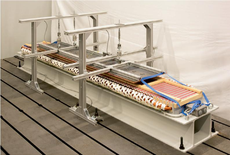
Bild 6.13: Gesamtansicht des Demonstrators zur Validierung der Simulation. Aufbau auf dem Maschinenbett des Antriebsstrangprüfstands in der Laborhalle des Instituts.
