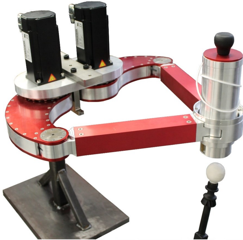
Abbildung 7-10: IPEK-Schaltroboter zur Prüfstandsautomatisierung
