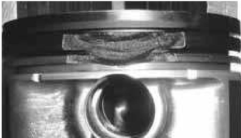
Abbildung 2.6: Typischer Vorentflammungsschaden: Kolbenringstegbruch [Winklhofer et al. (2005)]
