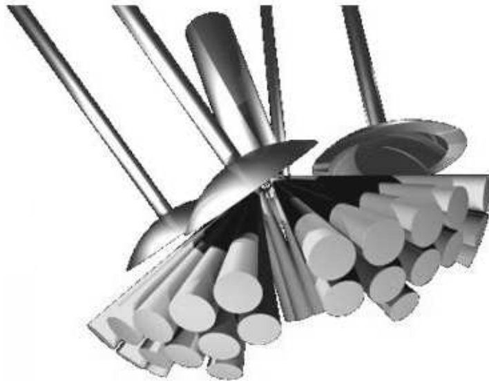
Abbildung 3.9: Lichtleiterzündkerze mit 80 Kanälen
