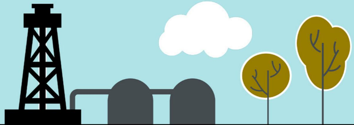
// So funktioniert Fracking: Rohre werden in die Erde gebohrt und der Raum zwischen Gestein und Rohren mit Zement gefüllt. Nun beginnt das eigentliche Fracking: Wasser, Sand und Chemikalien (Fracfluide) werden in das Rohr gepumpt. Dadurch entsteht ein so hoher Druck, dass das Gestein aufbricht. Die Fracfluide werden abgepumpt und das freiwerdende Öl oder Gas kann durch ein Rohr
