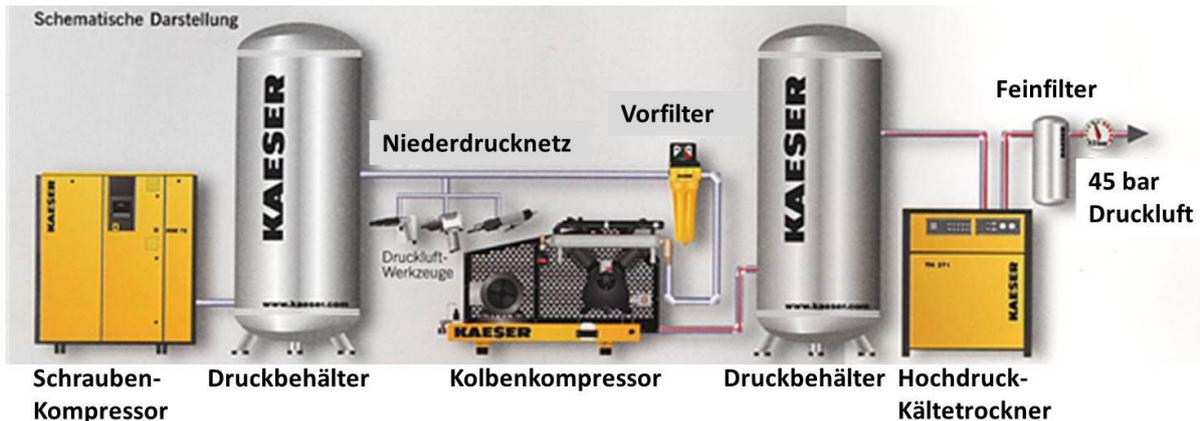
**Abbildung 3-6: Schematische Darstellung Hochdruck-Kompressor-Anlage Firma Kaeser [105]**
