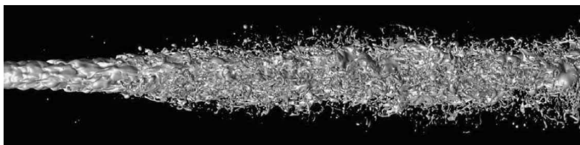
Abbildung 2.11: Visualisierung des mittels DNS berechneten Primärzerfalls von Lebas et al. (2009)
