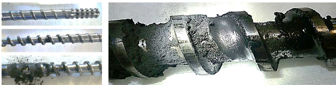
Abbildung 4-10: links: Schnecke nach Rückstau des Kokses und Weiterförderung des Etylenglykols rechts: Schneckenzone unter der Fluiddosierung nach dem Koksrückstau
