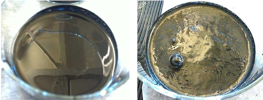
Abbildung 4-7: Gasblasenbildung im Koks-Ethylenglykol-Extrudat mit 35% Feststoffanteil links: frisch extrudiert, rechts: nach ca. 2 Stunden Lagerung
