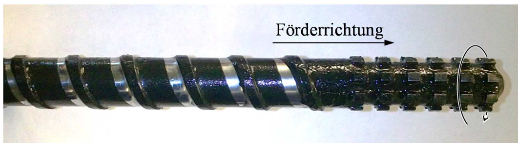
Abbildung 4-1: teilgefüllte Schneckengänge in der Meteringzone bei \dot{m}=370 g/h und c_w=40\%
