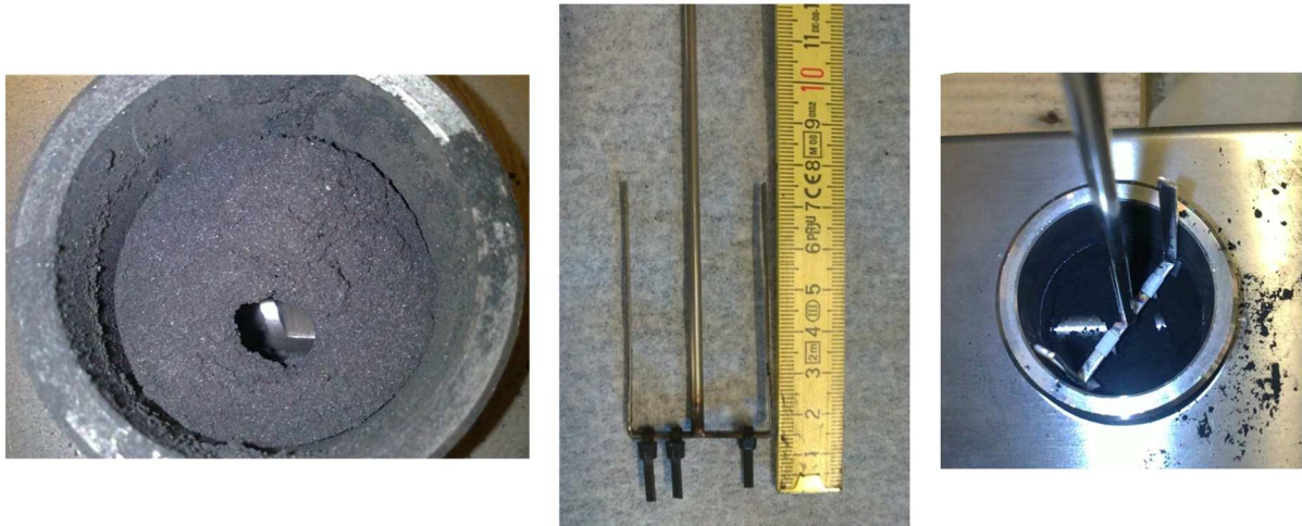
Abbildung 3-3: links: Koksstau in der Einfüllöffnung des Feeders in Folge von Brückenbildung mitte: konstruierter Rührer mit Rührblätter rechts: Platzierung des Rührers in der Einfüllöffnung des Feeders
