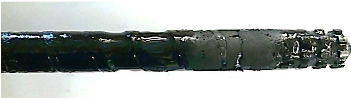
Abbildung 4-6: Schnecke nach Verstopfung des Extruders infolge einer feststoffreichen Zone in der Meteringzone
