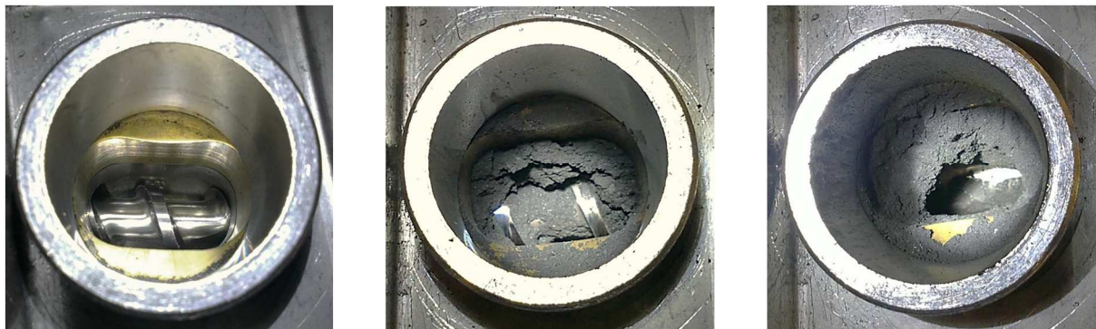
Abbildung 4-4: freie Einfüllöffnung (links), Wandhaftung (mitte) und Brückenbildung (rechts, n_{Feeder}=26 \text{ min}^{-1} , \dot{m}_{Koks}=715 \text{ g/h} ) in der Einfüllöffnung des Extruders in Folge hoher Feststoff-Dosieraten
