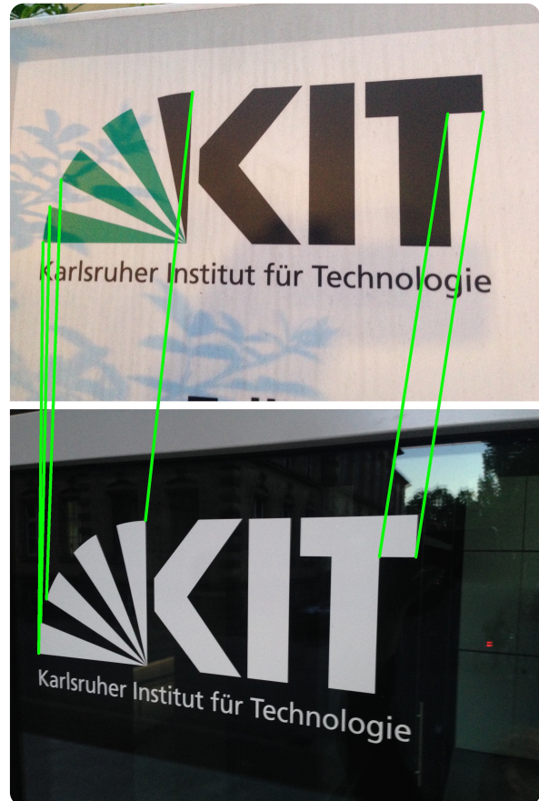
(b) Erfolgreiches Matching bei komplett unterschiedlichen radiometrischen Informationen. Einzig die zugrunde liegende Form des Logos ist dieselbe.
