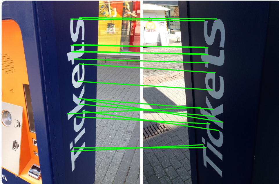
Abbildung 6.24: Ticket-Automat aus zwei unterschiedlichen Blickwinkeln aufgenommen. Die perspektivischen Effekte sind an der Schrift gut zu sehen. Auch die farblichen Unterschiede in beiden Bildern sind gut sichtbar. 17 Zuordnungen.
