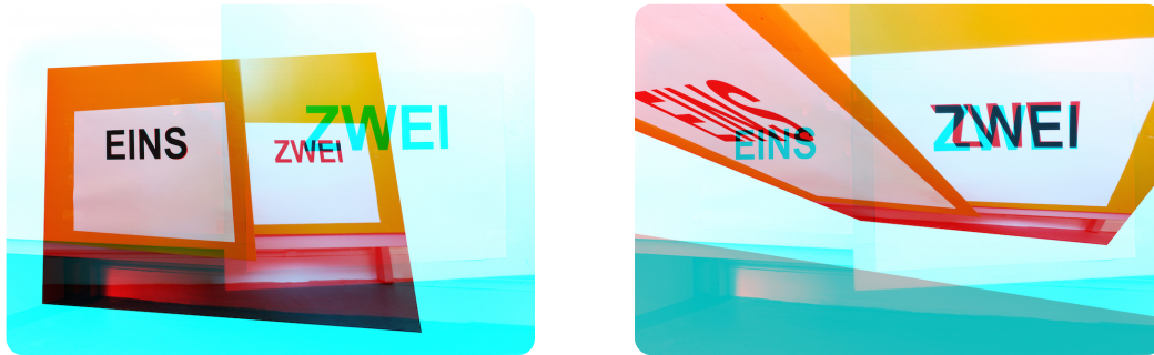
Abbildung 6.29: Bildüberlagerung der aufeinander transformierten Ebenen. Links für identische Punkte aus Ebene EINS , rechts für Punkte aus Ebene ZWEI .
