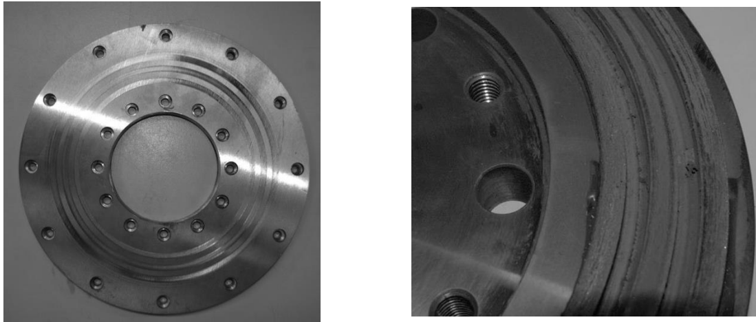
Abbildung 73: Reibbelag der Paarung P17 (rechts) und Gegenreibrscheibe nach dem Versuchsprogramm (links) – Es sind deutlich die drei Bereiche auf der Gegenreibrscheibe, in denen Reibkontakt stattgefunden hat, zu erkennen.
