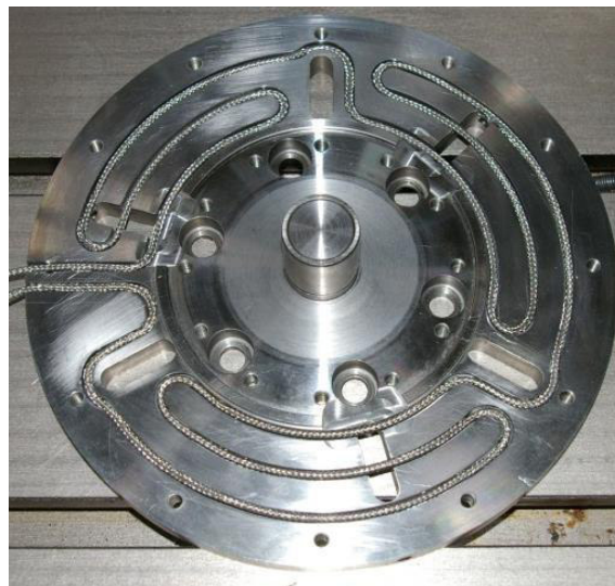
Abbildung 44: Adapterplatte mit eingelegter Heizschnur
