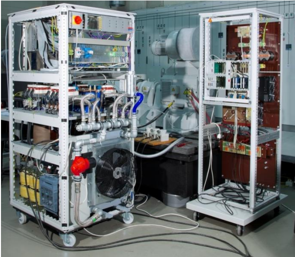
Aufbau Leistungselektronik (rechts: DC/DC-Wandler)
