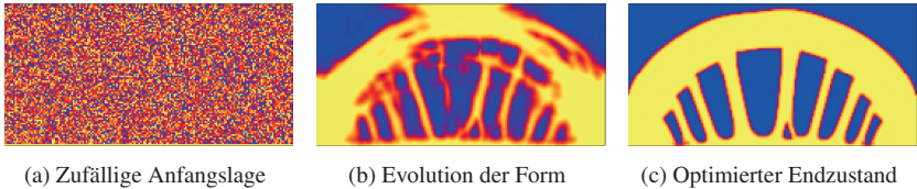
Abbildung 4.23: Optimierung einer Brückenstruktur aus einer zufälligen Anfangslage
