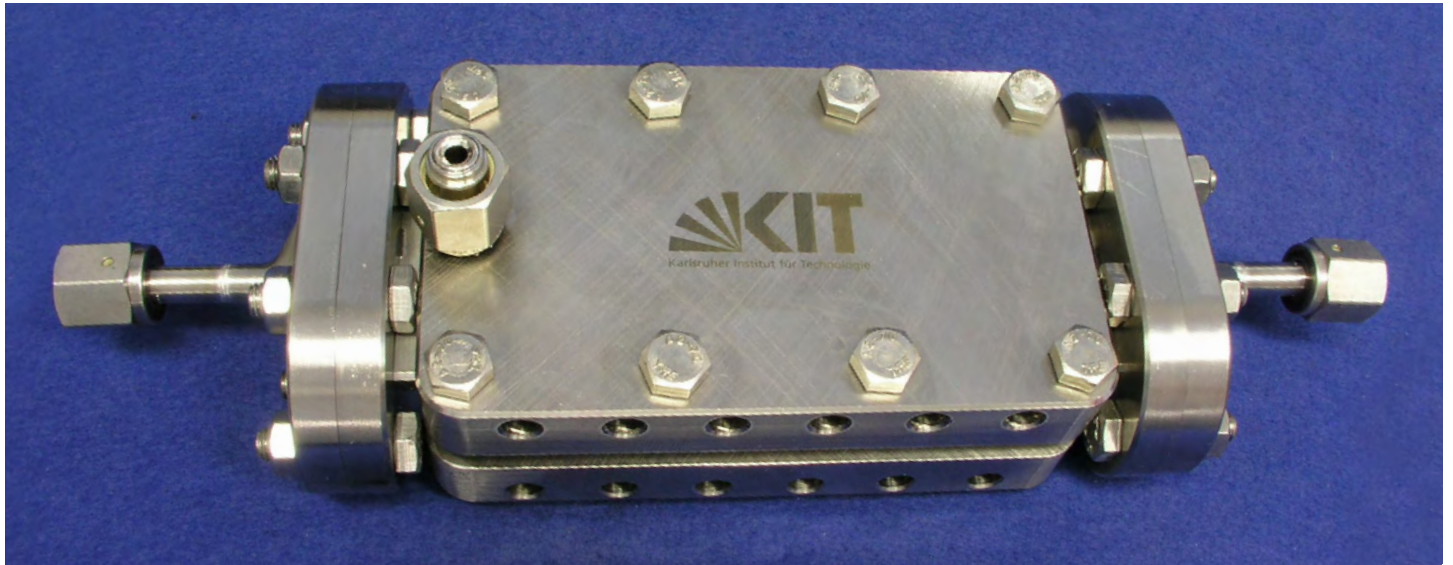
Reaktor für Hydrierungsreaktionen: Zur Anpassung der Produktionsmenge können weitere Schichten mit mikrostrukturierten Folien hinzugefügt werden.
