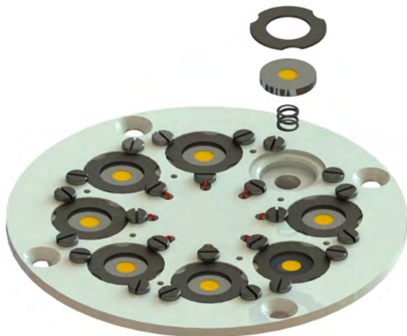
Drehbarer Probenträger: Federn drücken die Knopfzellen gegen Abdeckungen (dunkelgrau), Kabel (rot) sorgen für Verbindung zu einer Leiterplatte.
