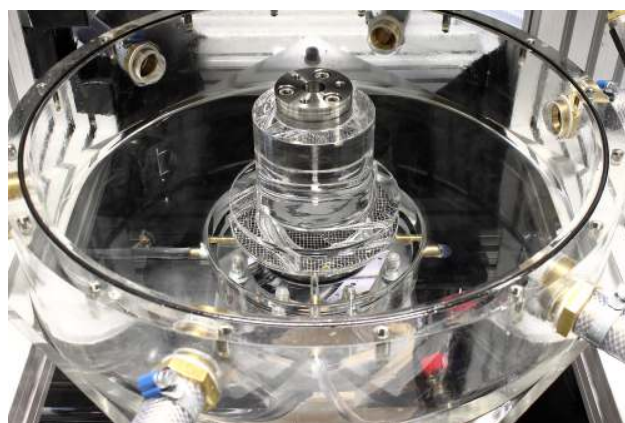
Abbildung 3.6.: Rotationssymmetrisches Pumpengehäuse mit D_{Gehaeuse} = 3 \cdot D_2
