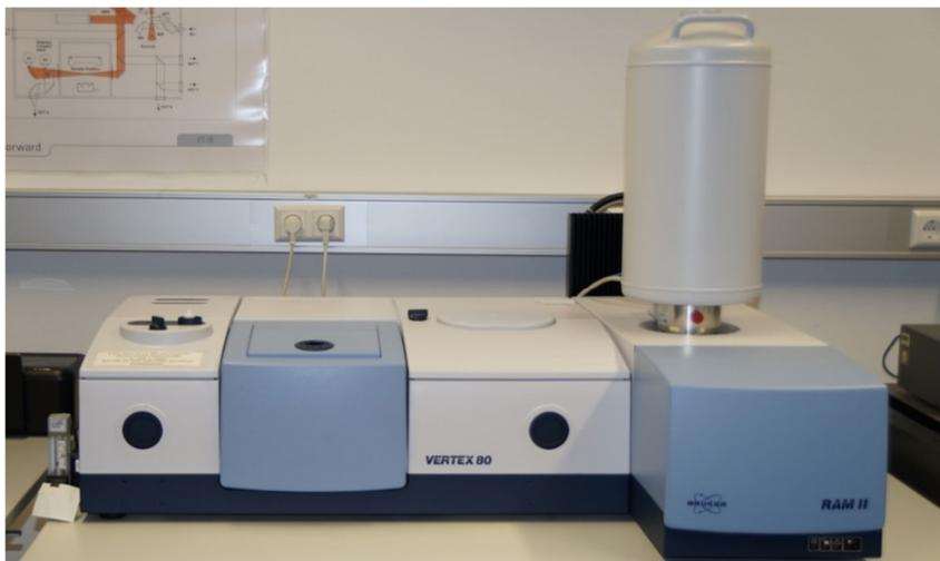
**Abbildung 19:** FTIR Spektrometer (Bruker Vertex 80) mit RAM II Modul.
