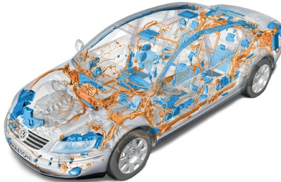
Abb. 2.1: Darstellung eines Bordnetzes in [127, S.654] - „Elektrikkomponenten (blau) und Bordnetz (braun) eines Oberklasse-Fahrzeuges“
