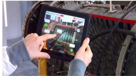
(a) Augmentierung einer mit Sensoren ausgestatteten Turbine. Quelle: [5]
