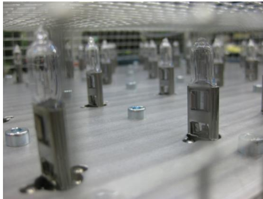
Abbildung 6-7: Lampenregister als Belastungseinheit des Generators
