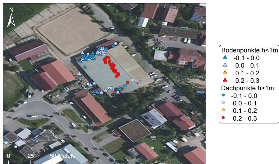
Abbildung 5.20: Beispiel für thermisch bedingte Bewegung der PS-Punkte auf dem Dach einer Industriehalle. Anhand der ermittelten PS-Höhe können die Punkte in Dachpunkte (Kreise) und bodennahe Punkte (Dreiecke) unterschieden werden. Die Farbe gibt die thermisch bedingte Bewegungsrate in mm/K an. Das Gebäude liegt am westlichen Rand des Gaisgraben-Gebietes (vgl. Abb.5.14). Quelle: Esri World Imagery, mit Satellitenbildern von SPOT 5, CNES/Airbus DS.
