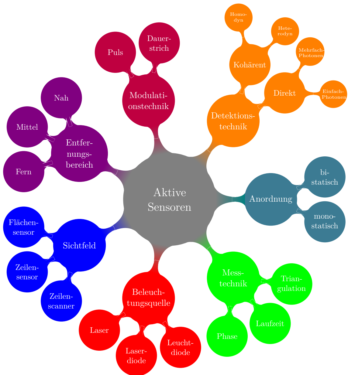
Abbildung 1.1: Taxonomie der aktiven Sensoren nach den Kategorien: Modulationstechnik, Detektionstechnik, Anordnung, Messtechnik, Beleuchtungsquelle, Sichtfeld und Entfernungsbereich.
