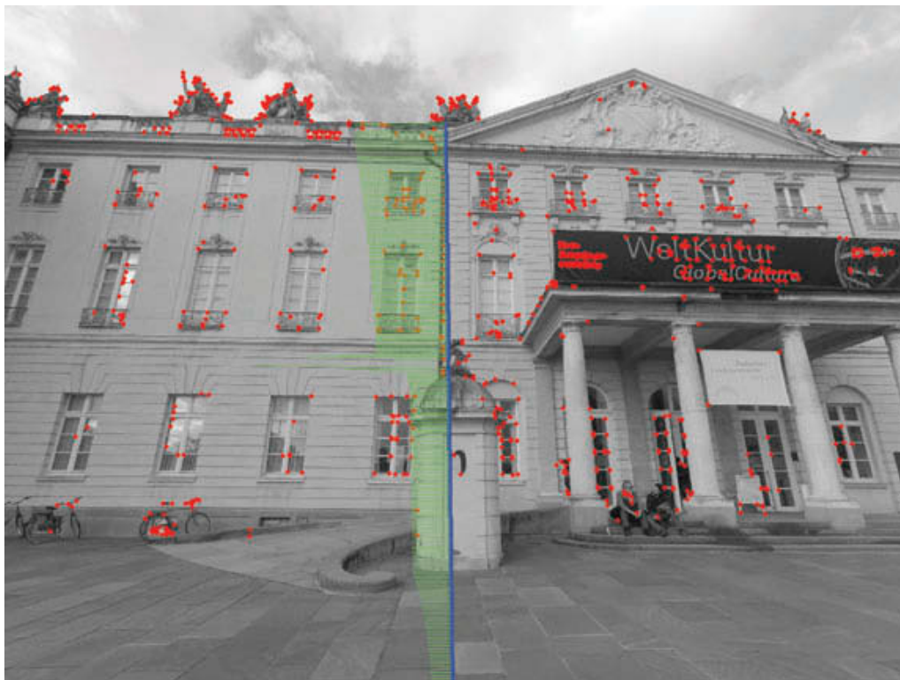
Abbildung 2.16: Visualisierung der 3D/2D-Koregistrierung zwischen mobilem Laserscanner und RGB-Kamera unter Berücksichtigung der geschätzten relativen Orientierung (rote Punkte: detektierte 2D-Punkte von auffälligen Bildbereiche; blaue Punkte, horizontal: Laserpunkte projiziert auf das dazu korrespondierende Bild; grüne Linien, vertikal: skalierte Repräsentation der Entfernungsmessungen für jeden projizierten Laserpunkt).
