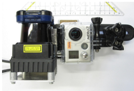
Abbildung 2.15: Mobiler Laserscanner Hokuyo UTM-30LX-EW (links) und RGB-Kamera GoPro 1080p HD HERO2 (rechts).
