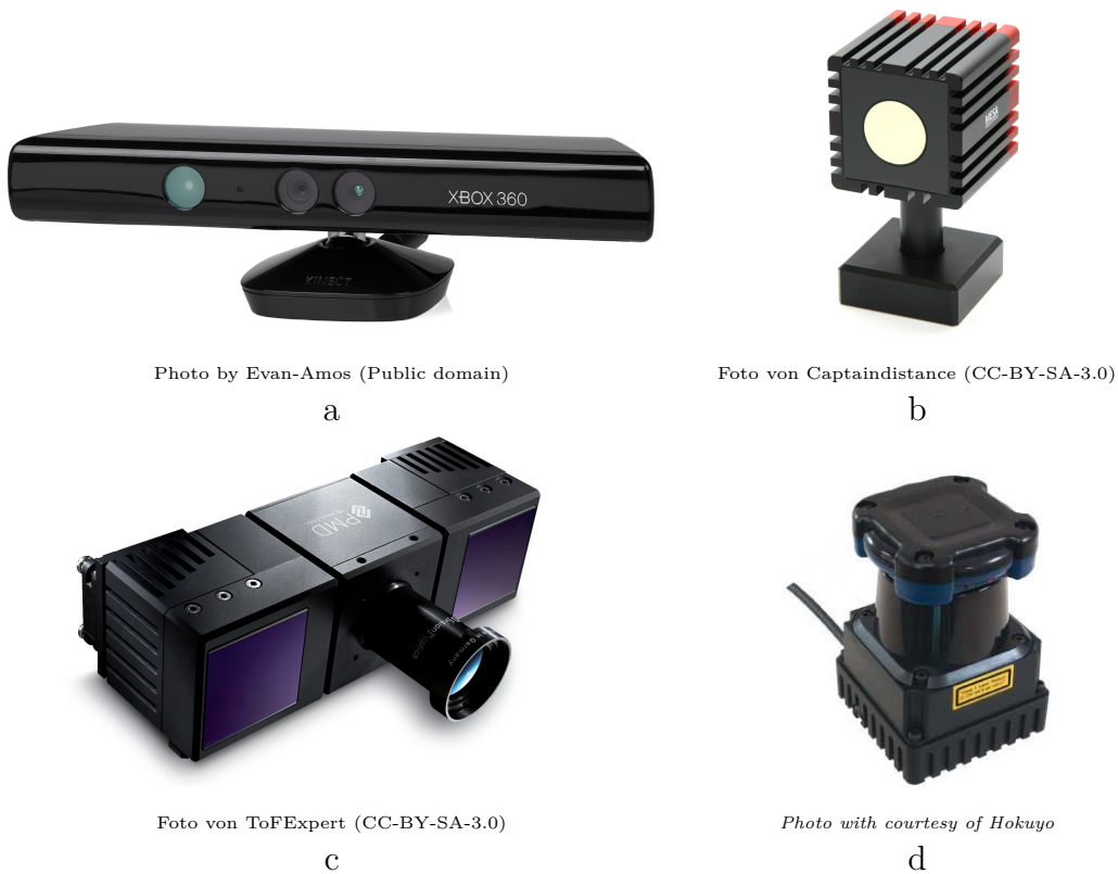
Abbildung 1.2: Aktive Sensoren die im nahen Entfernungsbereich messen: Strukturierte Lichtprojektion Sensoren (z.B. Microsoft Kinect 1.0 (a)), Time-of-Flight Entfernungskameras (z.B. MESA SR-4000 (b)), PMD CamCube 2.0 (c) und einfache Laserscanner (z.B. Hokuyo UTM-30LX (d)).
