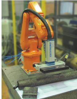
**Abbildung 13.1:** Robotergeführtes Kamerasystem mit Laser-Lichtschnittsensor.
