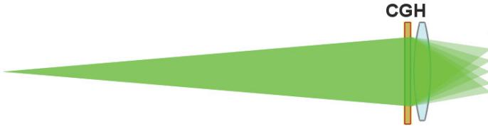
**Abbildung 21.1:** Prinzip der Bildvervielfachung durch ein computergeneriertes Hologramm (CGH) am Beispiel der Abbildung eines Punktes. Jeder objektseitige Punkt führt kameraseitig zu  $N$  Punkten, deren Position ermittelt wird. Eine Verschiebung des Objektpunktes führt im Bildraum zu einer simultanen Verschiebung aller  $N$  Punkte.
