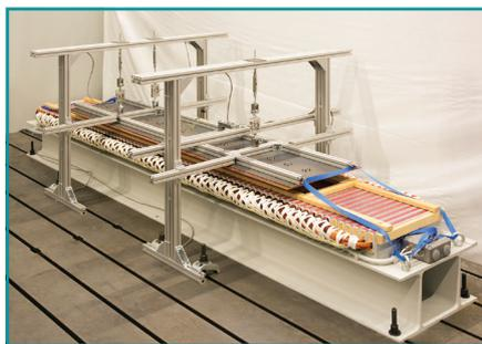
Abbildung 4: Der Linearmotor-Demonstrator auf dem Antriebssystemprüfstand.
