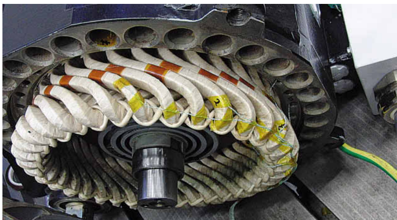
Wickelkopf einer Belastungsmaschine, ausgerüstet mit Thermoelementen für Erwärmungsmessungen
