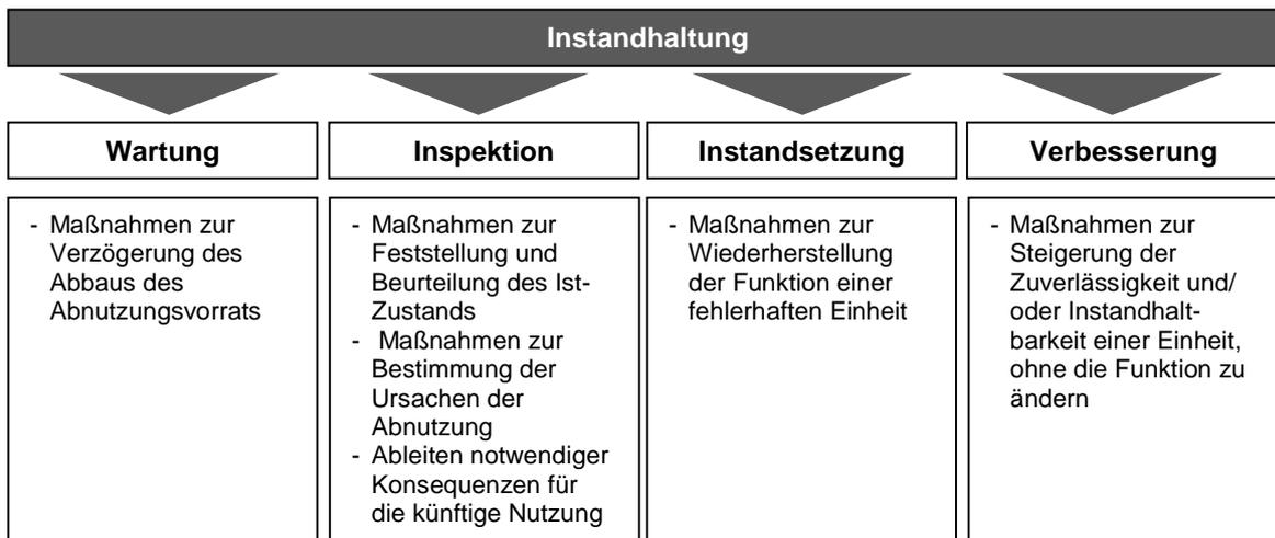
Abbildung 2-2: Übersicht der 4 Grundmaßnahmen der Instandhaltung nach DIN 31051:2012-09
