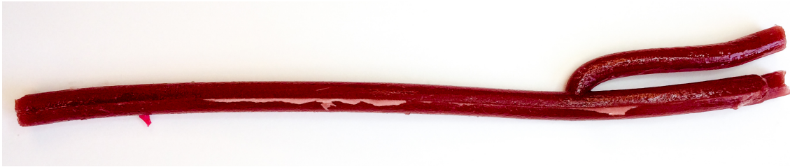
Abbildung 6.8.: Aus Silikon gegossenes Modell der Arteria carotis.
