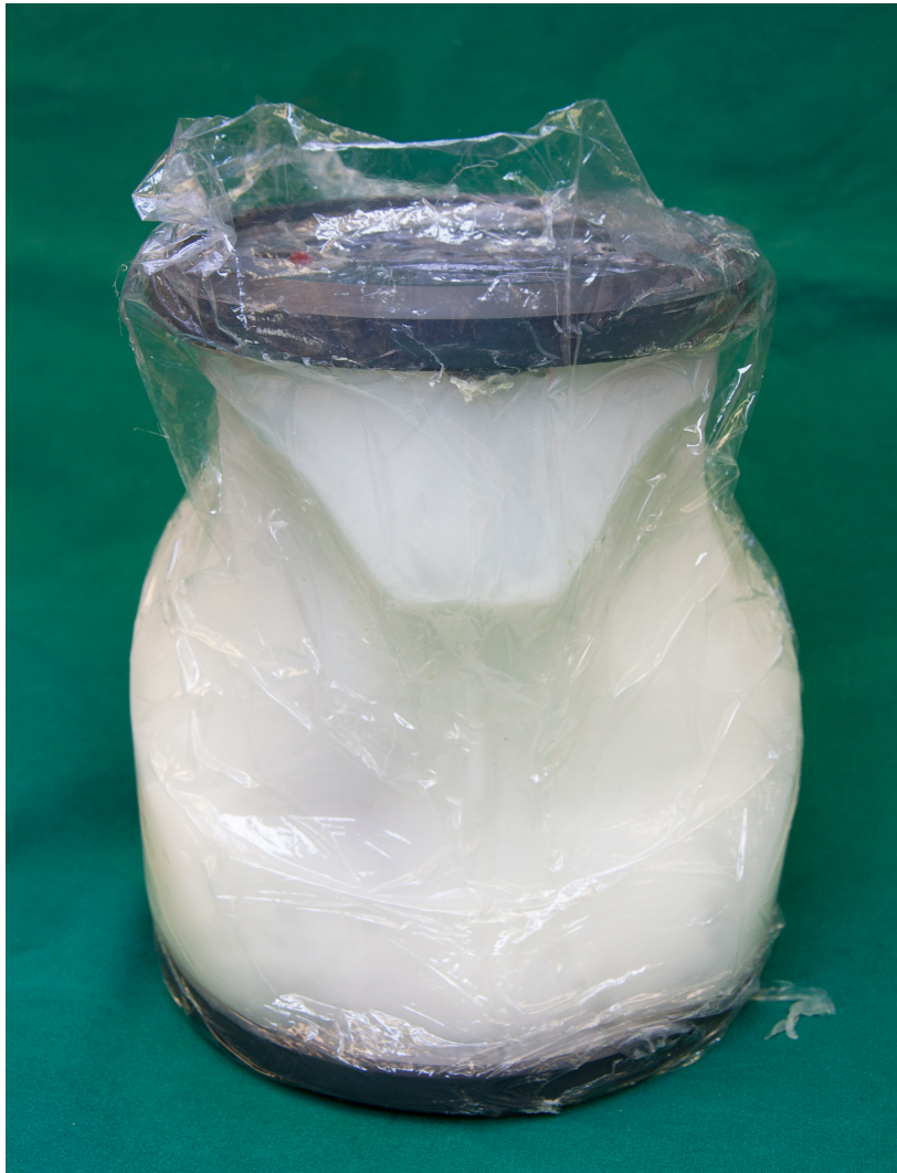
Abbildung 6.9.: Das hergestellte Halsphantom aus PVA. Zu erkennen sind auch die beiden Halteplatten. Die das Phantom umgebene Zellophanfolie schützt es vor Austrocknung.
