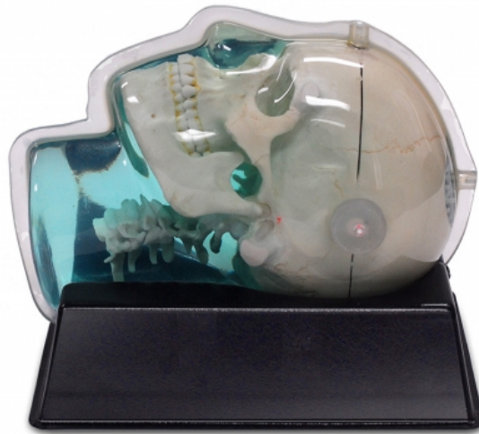
Abbildung 3.5.: Multimodales Kopf-Hals-Phantom von CIRS (MRI Distortion Phantom for SRS – Model 603A). Die anatomischen Nachbildungen von Schädelknochen und Halswirbelsäule sind von einem blauem, auf wasserbasiertem Polymer umgeben. (Quelle: [CIRb])
