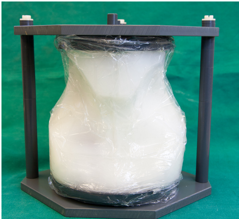
Abbildung 6.10.: Das Halsphantom in der entworfenen Halterung.
