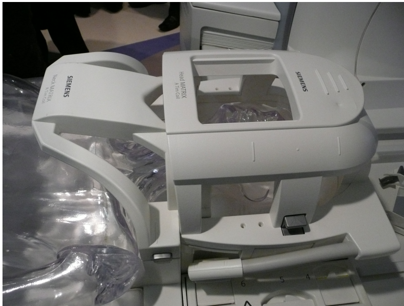
Abbildung 6.3.: Beispiel einer MRT-Kopfspule. (Quelle [Raz07])
