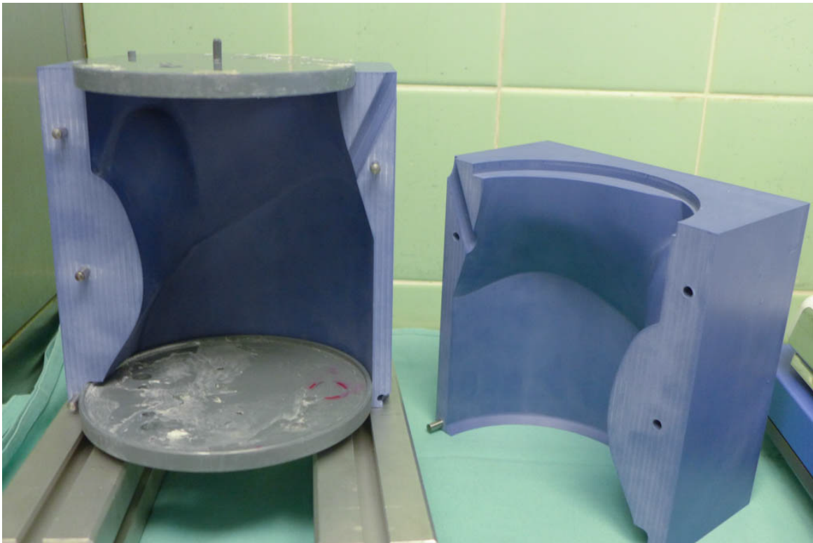
Abbildung 6.6.: Gefertigte Gussform mit eingesetzten Halteplatten aus Kunststoff, (links im Bild)
