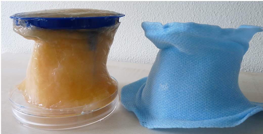
Abbildung 6.2.: Erstes Halsphantom (links). Auf der rechten Seite ist die verwendete Gussform zu sehen, die aus einem Halsabdruck resultiert.
