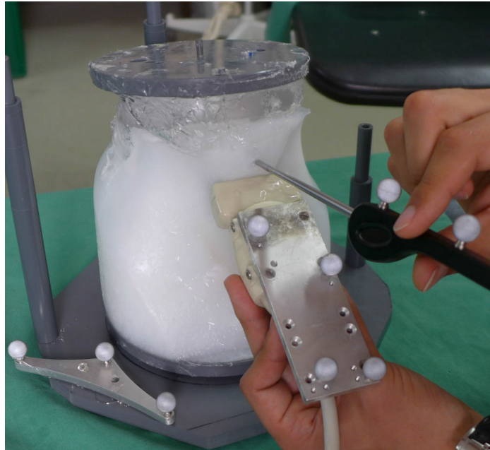
Abbildung 7.6.: Navigierte Punktion am Halsphantom: Versuchsdurchführung.
