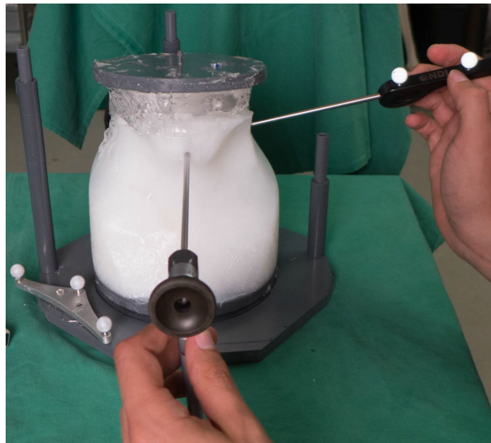
Abbildung 7.9.: Navigierte Punktion: Rendezvousmanöver zweier Instrumente. Der Arbeitskanal des Endoskops wurde zuvor mit dem Zeiginstrument geschaffen.
