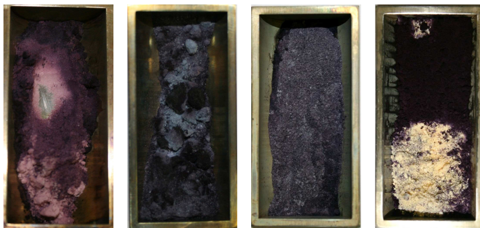
Abbildung 4.43: Fotos der Proben nach der simultanen, bimetallischen AuFe-Abscheidung. (v.l.n.r.) Versuch 92, 102, AG03 und AG06. ( T = 373 \text{ K} , p = 15,5 \text{ MPa} , weitere Prozessbedingungen finden sich in Tabelle C.9 im Anhang C.1)
