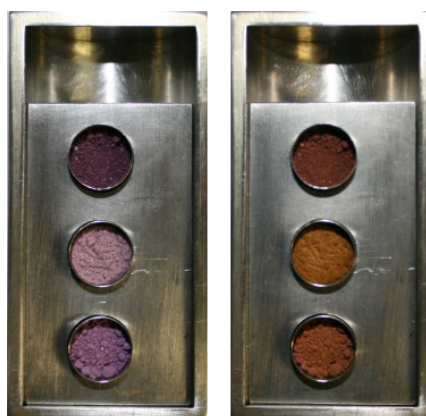
Abbildung 4.37: Fotos von Proben der Ag-Abscheidung auf Au/ \gamma -Al 2 O 3 (oben), Au/ \beta -CD (Mitte) und Au/TiO 2 (unten); Vorher (links) und nachher (rechts).
