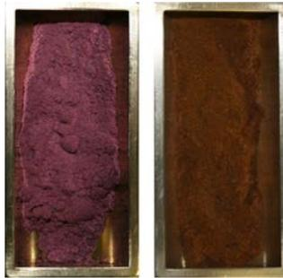
**Abbildung 4.34:** Fotos der Produkte der konsekutiven AuAg-Abscheidung auf  $\beta$ -CD; Au/ $\beta$ -CD (links) und Ag auf Au/ $\beta$ -CD (rechts).
