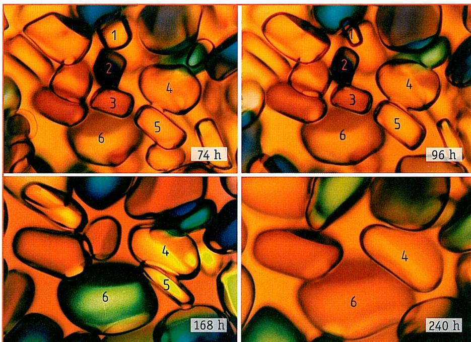
Abb. 9: Vergrößerung des Eiskristallgefüges in einer 40 %-igen Saccharoselösung mit Zusatz von 0,2 % Na-alginat während der Lagerung bei sinusförmig schwankenden Temperaturen: Temperaturamplitude =  $4\text{ °C}$ , Periodendauer =  $1,5\text{ h}$ ,  $T_{\text{Mitte}} = -12\text{ °C}$ . (Gaukel, V. 1997)
