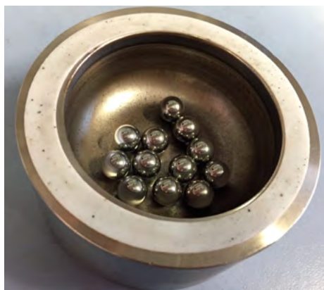
Zum Hochenergiekugelmahlen wird ein Mahlbecher mit Mahlkugeln in einer Planetenmühle eingesetzt. Batteriematerial kann so stark verdichtet werden.
