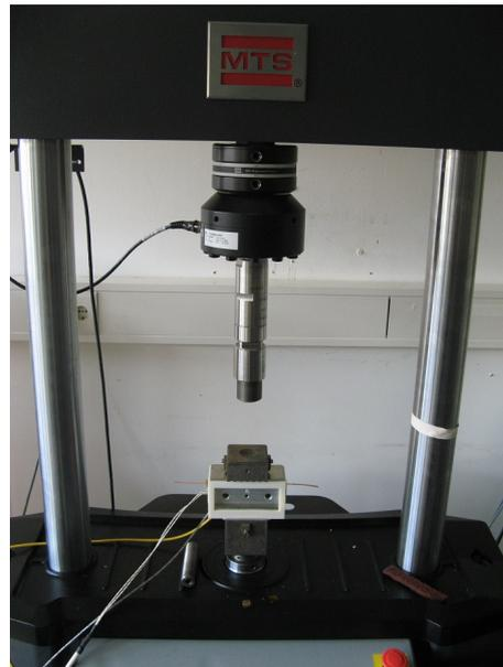
Abbildung 4.4.: Die für die Komprimierung verwendete Zug-Druck-Maschine im CryoMak Labor
