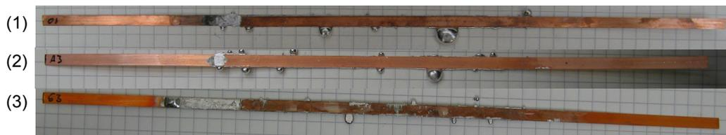
Abbildung 4.6.: Verlötete Supraleiterpaare unterschiedlicher Lote
