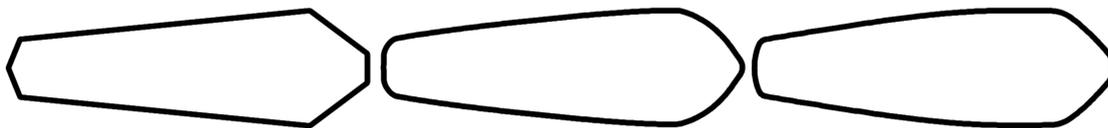
Abbildung 3.7: Von links nach rechts: Das Eingabepolygon, das vom konvexen Schema mit  $w = 1/16$  und  $c = 0,9$  und natürlicher Tangentenwahl unterteilte Polygon und das vom glatten Schema mit  $\sigma = \tau = 1/2$  unterteilte Polygon.
