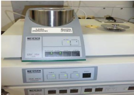
Abbildung 3.5: Das dynamische Differenzialkalorimeter von der Firma Netzsch.
