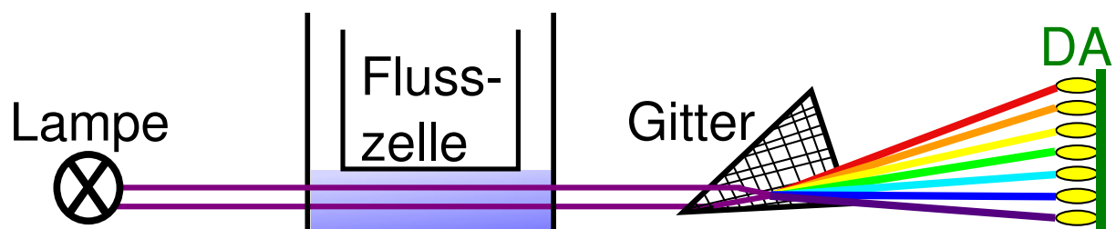
Abbildung 2.18: Skizze des Aufbaus eines Diodenarray-Detektors, abgeändert nach den aufgeführten Quellen. Polychromatisches Licht strahlt durch eine Flusszelle, auf ein Gitter, das dieses Licht spektral aufteilt. Der Lichtfächer wird auf das Diodenarray (DA) geleitet. [49, 50]
