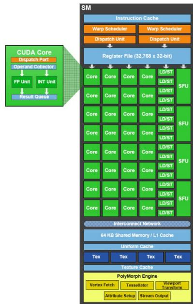
**Abbildung 28 Streaming Multiprozessor (SM) mit integrierten Komponenten**
