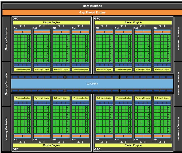
**Abbildung 29 Fermi-Architektur mit 16 Stream-Multiprozessoren (SMs), L2 Cache, Memory Controllern, Giga Thread Engine und Host Interface**
